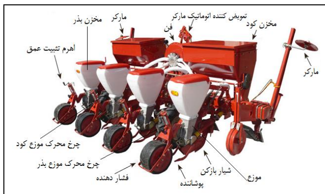
شکل ۴- اجزاء ردیف‌کار پنوماتیکی
