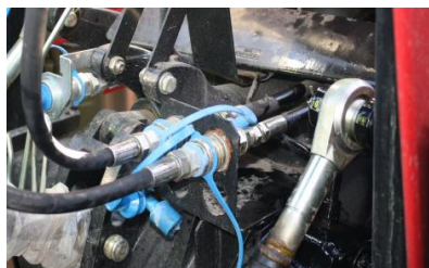
شکل ۱۴- اتصال شیلنگ‌ها به کوپلر خروجی‌های یدکی تراکتور
