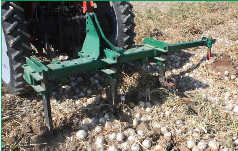
شکل ۱۲- پیازکن تیغه‌ای در حین عملیات پیازکنی
