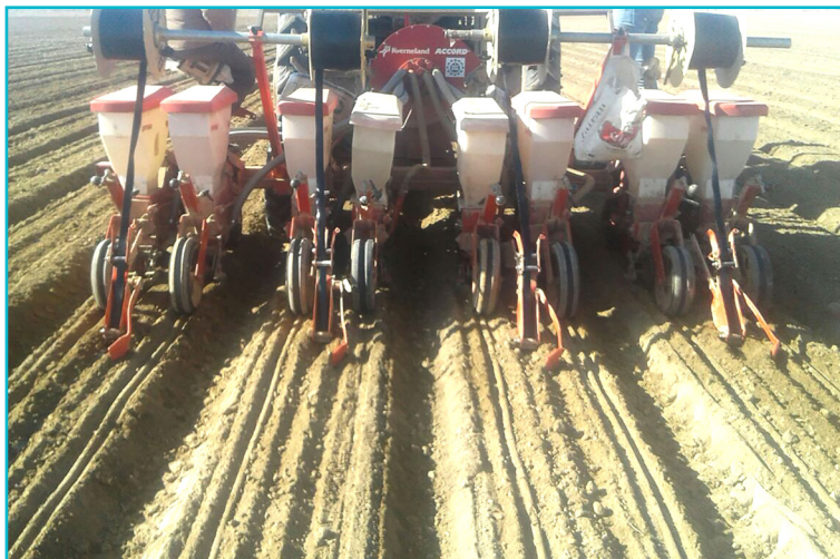
شکل ۲۶- یک نمونه وسیله پهن کردن نوارهای تیپ
