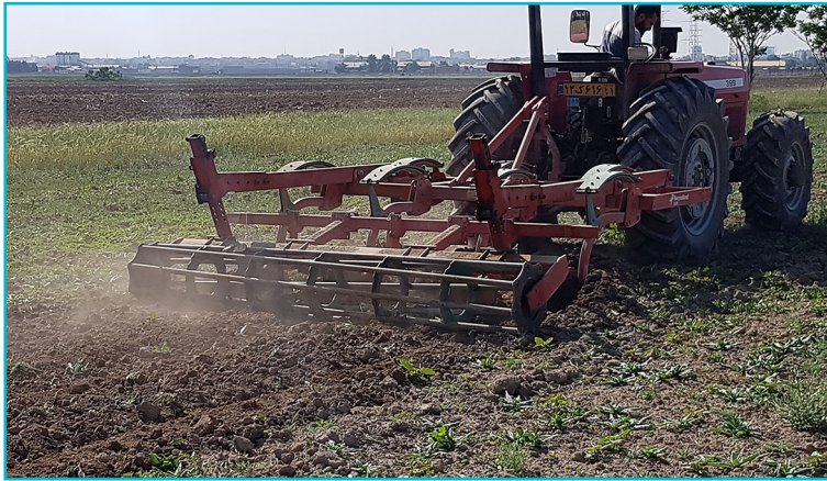
شکل ۹- استفاده از دستگاه خاک‌ورز مرکب برای آماده‌سازی بستر کاشت باعث کاهش تردد ماشین‌آلات در زمین می‌شود.
