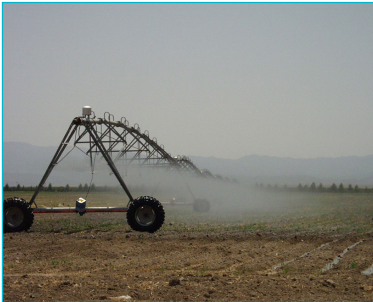
شکل ۱۹- روش آبیاری سنتریوت در زراعت چغندر قند
