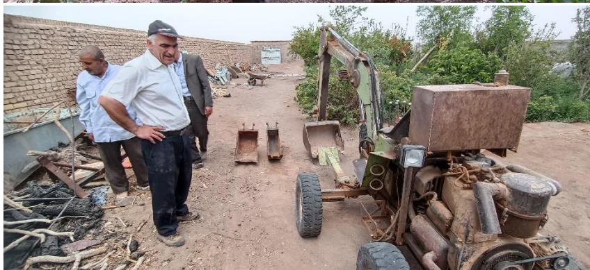
تصویر ۱۳- ماشین حفر ترانشه در باغ (ابداعی کشاورز پیشرو)
