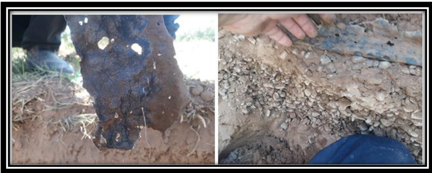
تصویر ۲۱- سوراخ شدن مشمع در اثر نفوذ ریشه در آن
