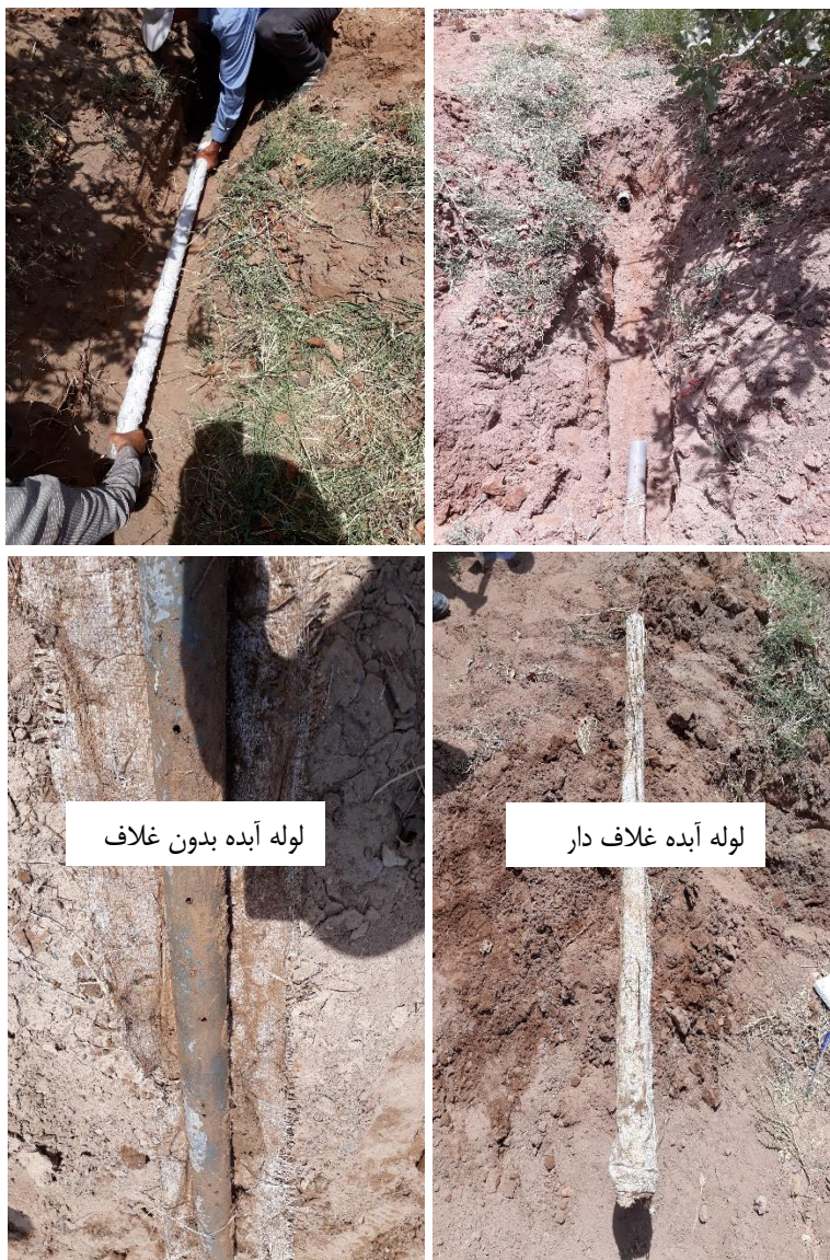
تصویر ۱۲- یک نمونه از لوله آبدۀ غلاف دار ( برش داده شده از خط لوله آبدۀ )
