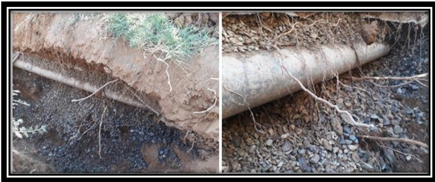
تصویر ۲۳- تجمع ریشه در اطراف لوله آبده در منطقه بردسکن از توابع خراسان رضوی (پایلوت ۳ ساله)
