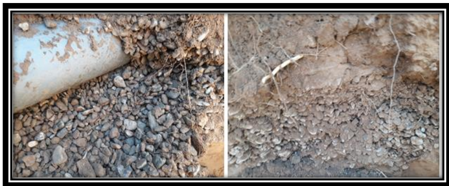
تصویر ۲۴- تجمع ریشه در اطراف لوله آبدۀ در منطقه بردسکن (پایلوٹ ۶ ساله روی درختان جوان)
