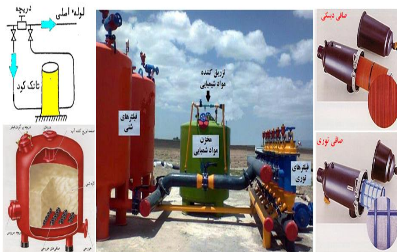
شکل ۲- نمونه‌ای از تجهیزات یک سامانه کنترل مرکزی آبیاری قطره‌ای
