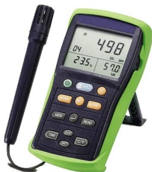
شکل ۳- حسگر دی اکسید کربن مادون قرمز غیر پراکنده (NDIR)
