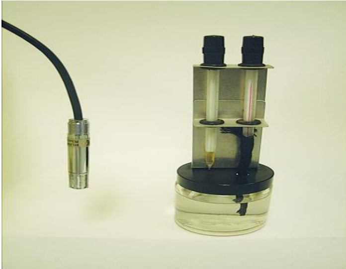
شکل ۲. نمونه‌هایی از حسگرهای بخار آب (رطوبت)، سمت چپ رطوبت سنج خازنی نسبتاً ارزان قیمت و سمت راست روان سنج اولیه گران‌تر
