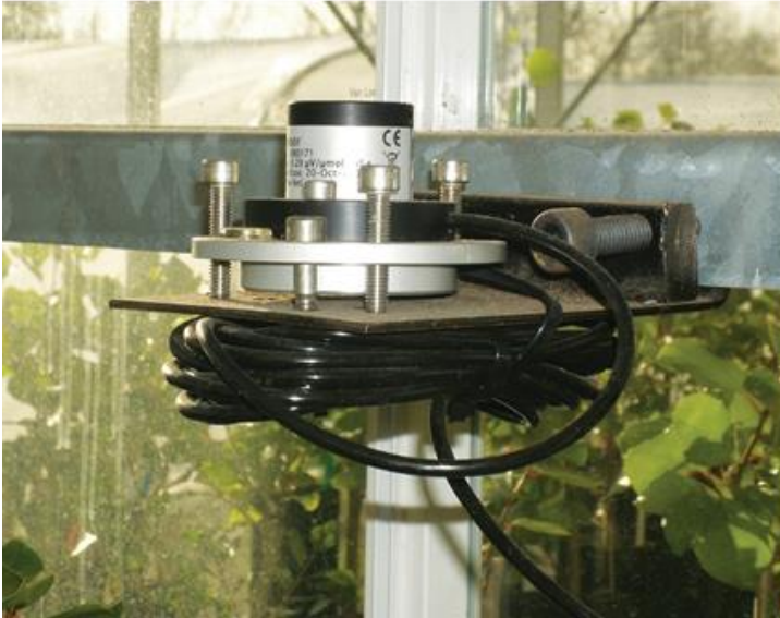
شکل ۱. حسگر کوانتومی نصب شده روی یک صفحه تراز در بالای پوشش گیاهی برای اندازه‌گیری تابش فعال فتوسنتزی (PAR).
