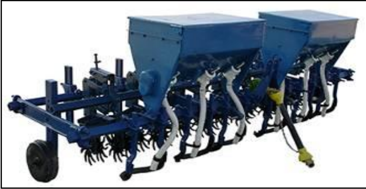
شکل ۵ - کولتیواتور ردیفی (وجین کن) مجهز به کودریز و تیغه‌های چرخان (انجام عملیات دفع علف‌های هرز، کوددهی، خاک‌دهی و شکل‌دهی پشت‌ها به‌طور هم‌زمان)
