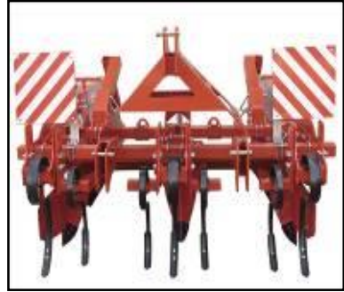
شکل ۳- کولتیواتور ردیفی با تیغه‌های قلمی و مجهز به شیب‌بر (انجام عملیات، خاک‌دهی و شکل‌دهی پشته‌ها به‌طور هم‌زمان)
