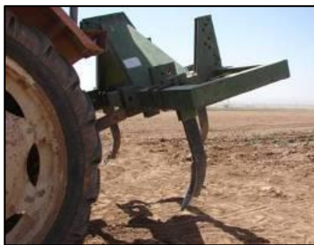
شکل ۸- گاواهن قلمی تغییر یافته سه ردیفه جهت عملیات خاک‌ورزی بین ردیفی
