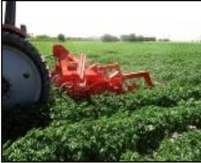
شکل ۳- کولتیواتور ردیفی با تیغه‌های قلمی و مجهز به شیب‌بر (انجام عملیات، خاک‌دهی و شکل‌دهی پشته‌ها به‌طور هم‌زمان)
