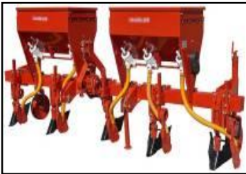
شکل ۶- کودکار فاروئر: الف- زمین گرد، ب- پی‌تی‌او گرد (عملیات کوددهی و خاک‌دهی باهم انجام می‌شود)
