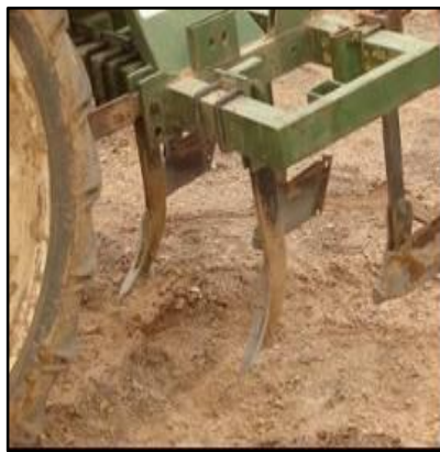
شکل ۱۰- انجام هم‌زمان عملیات خاک‌ورزی بین ردیفی با گاواهن قلمی و خاک‌دهی پایه بوته‌ها
