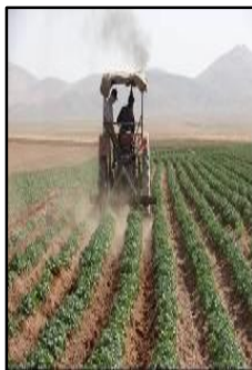
شکل ۹- عملیات خاک‌ورزی بین ردیفی با گاواهن قلمی در زمان‌های متفاوت
