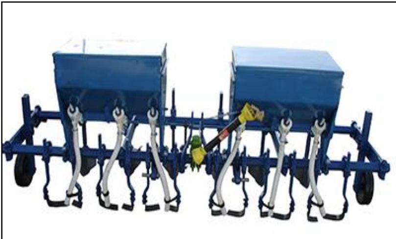
شکل ۴- کولتیواتور ردیفی مجهز به کودریز (انجام عملیات دفع علف‌های هرز، کوددهی، خاک‌دهی و شکل‌دهی پشته‌ها به‌طور هم‌زمان)
