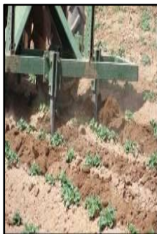
شکل ۹- عملیات خاک‌ورزی بین ردیفی با گاواهن قلمی در زمان‌های متفاوت
