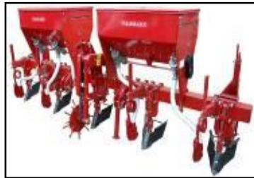
شکل ۶- کودکار فاروئر: الف- زمین گرد، ب- پی‌تی‌او گرد (عملیات کوددهی و خاک‌دهی باهم انجام می‌شود)
