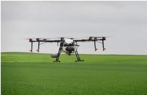
شکل ۱۹- استفاده از پهپاد برای سمپاشی مزارع گندم
