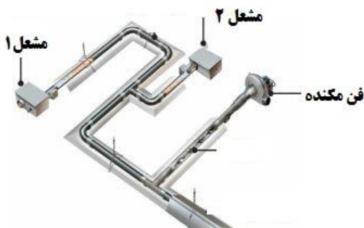
شکل ۸- سامانه گرمایش تابشی چند مشعلی (سجادی و همکاران، ۱۴۰۰).
