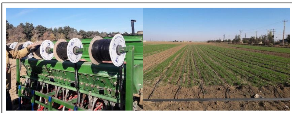
شکل ۱۲- دستگاه کمینات بذرکار و پهن کننده نوار آبیاری قطره‌ای (تیپ) (به صورت همزمان)
