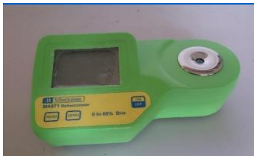
شکل ۲- رفاکتومتر دیجیتالی پرتابل برای اندازه‌گیری TSS
