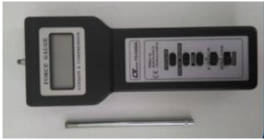
شکل ۳- نفوذسنج دیجیتالی پرتابل به همراه پروب
