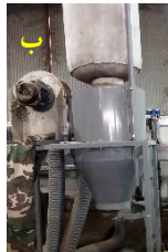
شکل ۸- الف) سورتینگ دستی؛ ب) سایکلون؛ ج) سورتینگ اتوماتیک
