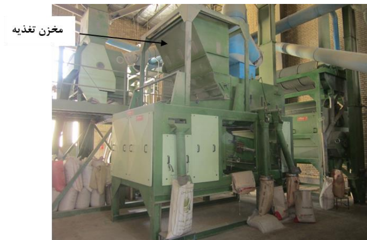
شکل ۱۵- مخزن تغذیه ماشین بوجاری
