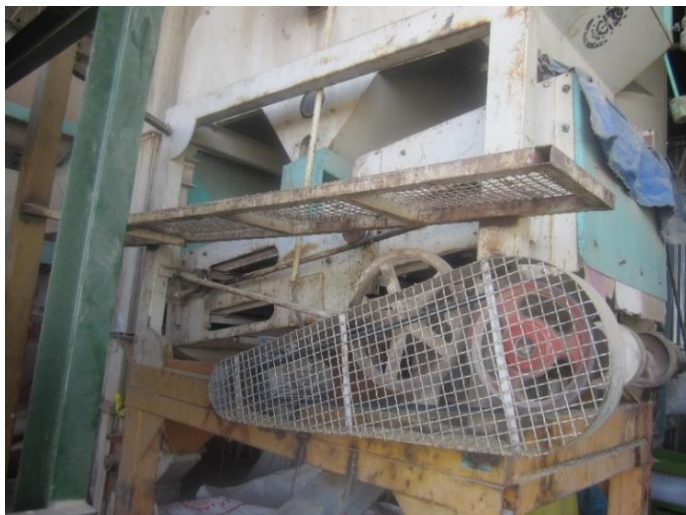
شکل ۲۰- جاروی تمیز کردن غربال بذر ماشین بوجاری در شرکت کشت گستر ۸۷ مرودشت فارس
