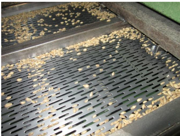
شکل ۱۷- الک رویی با حفرة کشیده با عرض ۳ میلی‌متر
