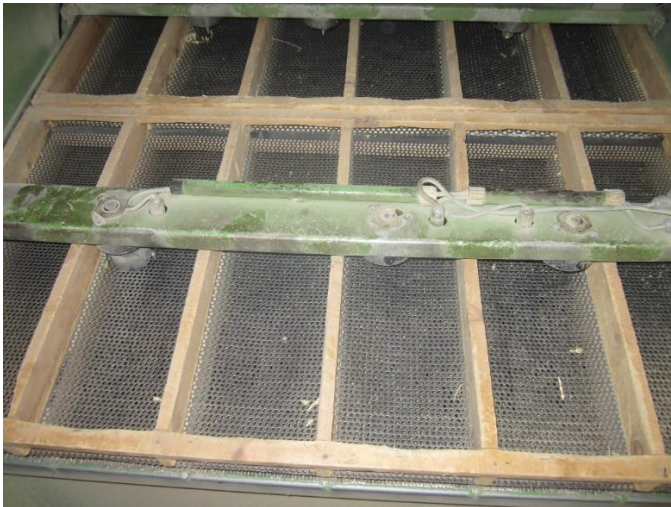
شکل ۱۶- الک رویی با حفره گرد دارای قطر ۵ میلی‌متر
