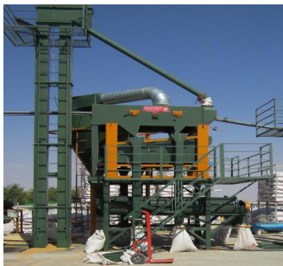
شکل ۱۳- نمونه هایی از ماشین‌های بوجاری سیار پشت تراکتوری و ثابت مورد استفاده در فرآوری بذر گندم
