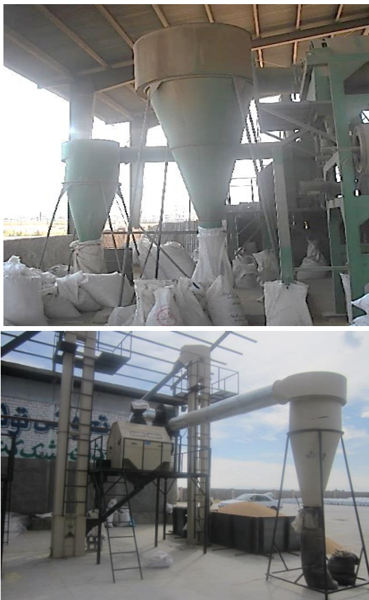
شکل ۹- برخی از جدا سازهای سیکلونی در ماشین‌های پیش بوجار شرکت آذران بوجار ایرانیان
