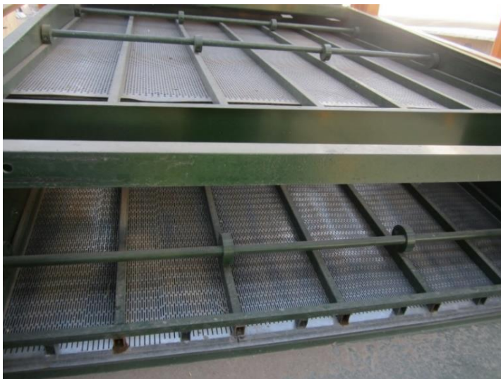
شکل ۴- سرندهای تخت ماشین پیش بوجار گندم دارای حفره های گرد و کشیده
