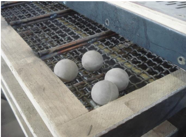
شکل ۱۹- توپک‌های مورد استفاده در غربال‌های ماشین بوجاری بذر
