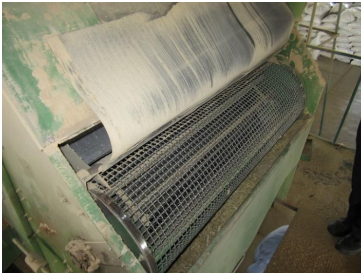
شکل ۳- سرنده دوار ماشین پیش‌بوجار شرکت آروین صنعت
