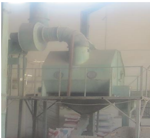
شکل ۷- محفظه باد در ماشین پیش‌بوجار شرکت آر ماشین
