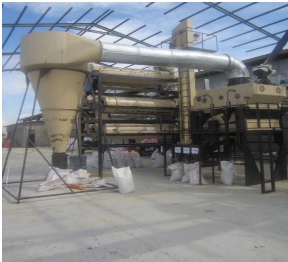
شکل ۲۲- جداساز سیکلونی در ماشین بوجار ساخت شرکت آذران بوجار ایرانیان
