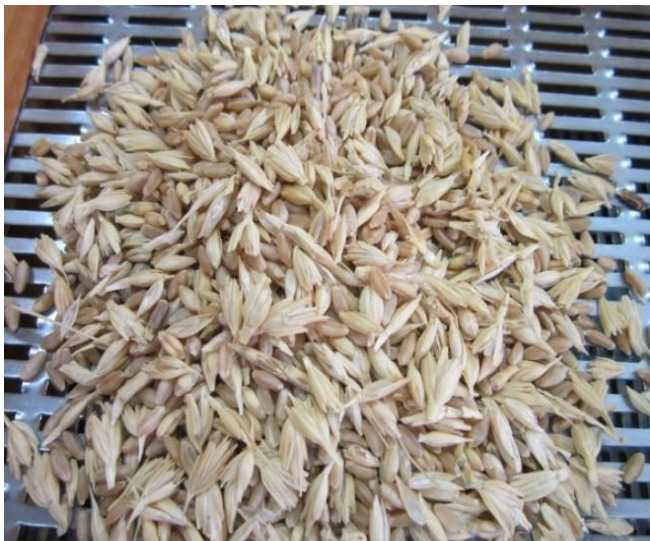
شکل ۲۴- ضایعات روی الک در ماشین بوجاری
