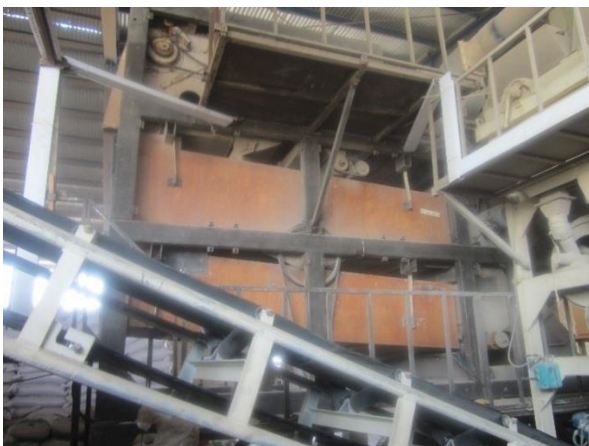
شکل ۱۸- سیستم ارتعاشی و چوب هندی به کار رفته در ماشین بوجار
