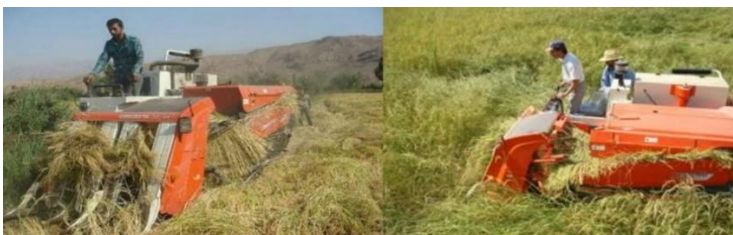
شکل ۳- کمباین برداشت برنج از نوع خوشه تغذیه (هد فید) (یوسفی، ۱۴۰۰)
