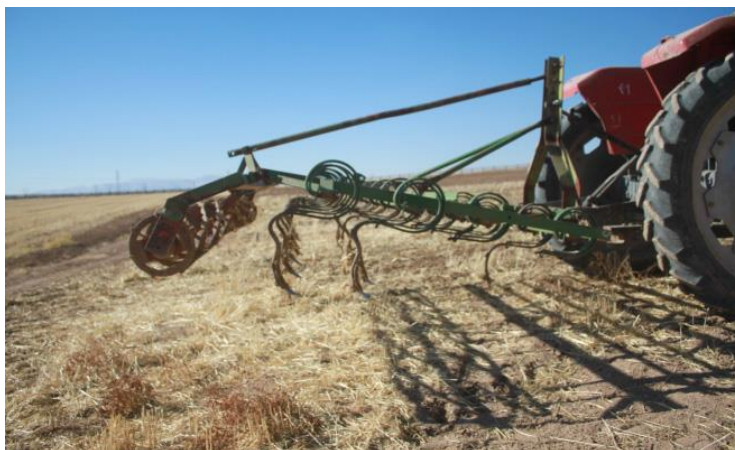
شکل ۴- آماده‌سازی بستر بذر با استفاده از خاکورزهای مرکب
