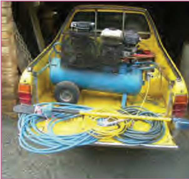
شکل ۸۹- الزام به حمل‌ونقل دستگاه شاخه‌تکان‌های مستقل از تراکتور در باغ توسط وانت، به سبب سنگینی و چرخ‌های کوچک آن‌ها
