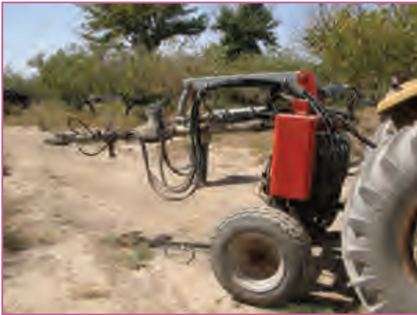
شکل ۹۸- بازکردن چادر تخریب شده تنه تکان تراکتوری در ایران به علت رعایت نکردن فاصله مناسب درختان
