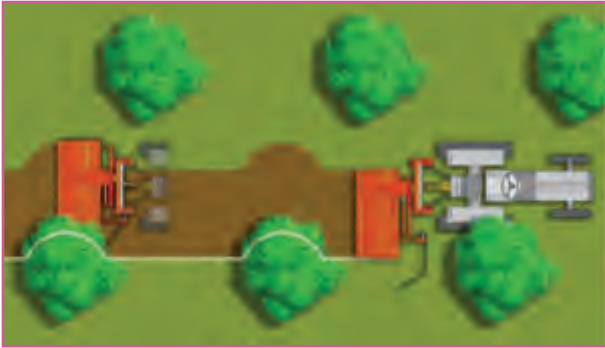
شکل ۶- قرارگیری تیلر دوار سنسوردار در یک طرف تراکتور و قابلیت کار در سایه‌انداز درختان پسته
