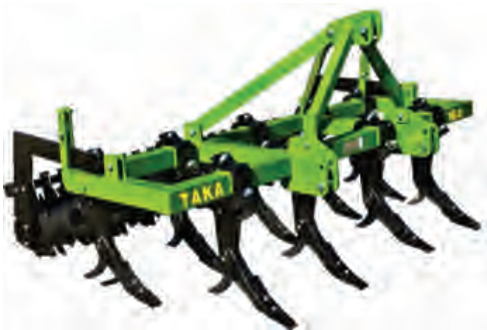
شکل ۸- خاک‌ورز مرکب (گاوآهن قلمی با تیغه پنجه‌غازی همراه با بشقاب‌ها و غلتک خردکننده کلوخ)
