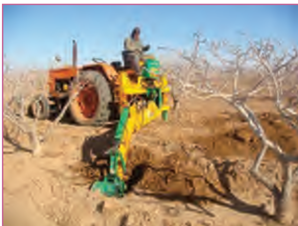
شکل ۵۹- بالا: حفر کانال کود با بیل مکانیکی؛ پایین: حفر چال کود با بیل مکانیکی سوار بر تراکتور
