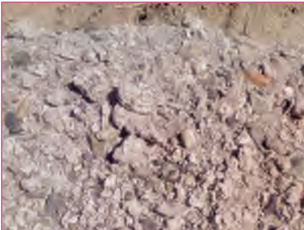
شکل ۶۹- گچ مخصوص مورد استفاده در باغ‌های پسته به منظور بهبود خصوصیات فیزیکی خاک
