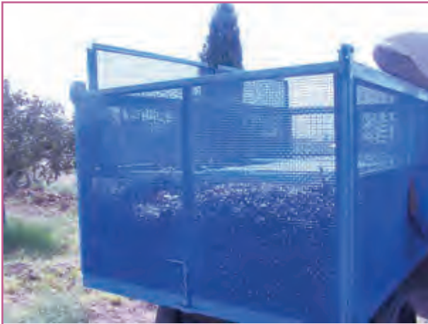
شکل ۱۰۰- تریلی جدید ساخته شده برای حمل پسته تر از باغ به پایانه فراوری
