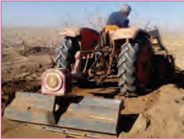
شکل ۷۲- پخش ماسه در سطح باغ‌های پسته با استفاده از تیغه بولدوزر متصل به تراکتور
