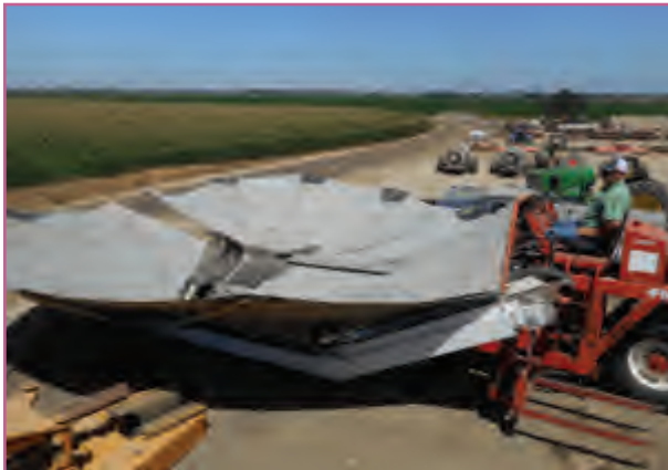
شکل ۹۷- تنه‌تکان خودرو دارای چادر خودکار با شعاع ۲/۵ متر در حالت بسته (بالا) و باز (پایین)
