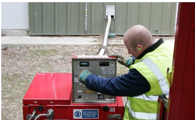
شکل ۳۴- تزریق گاز گرم کلروپروفام به انبار سیبزمینی منبع: (کانینگتون و ماوسون، ۱۹۹۷)
