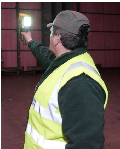
شکل ۳۰- استفاده از دوربین حرارتی برای شناسایی درز و شکاف موجود در سطوح عایق شده انبار
