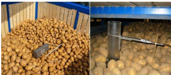
شکل ۱۴- نحوه صحیح قرارگیری حسگر دما در سطح توده سیب زمینی انبار شده. منبع: (پرینگل و همکاران، ۲۰۰۹)
