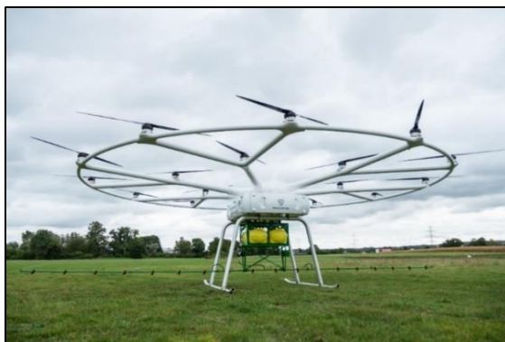
شکل ۱۴- پهپاد سمپاش ۱۸ موتور به مجهز به بوم ۹ متری و مخزن با ظرفیت ۲۰۰ لیتر
