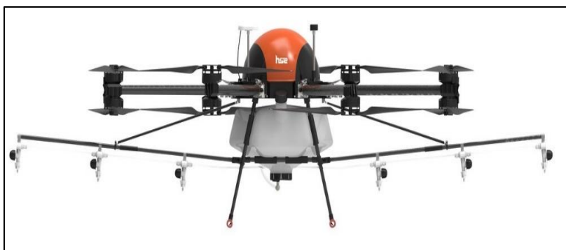
شکل ۱۳- نمونه ای از پهپاد سمپاش شش موتور (هگزاکوپتر) مجهز به بوم سمپاشی
