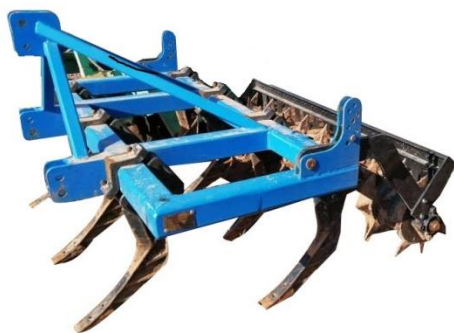
شکل ۲۲- گاواهن قلمی غلتک‌دار (چیزل پکر یا چیزل پیلر)
