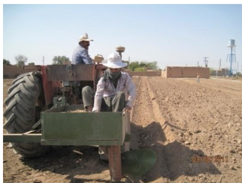
شکل ۲۸- گاواهن تک‌خیش شده به همراه مخزن پیاز
