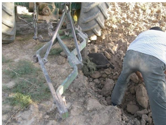
شکل ۷- گاواهن برگردان‌دار تک‌خیش برای برداشت و کندن پیازهای زعفران
