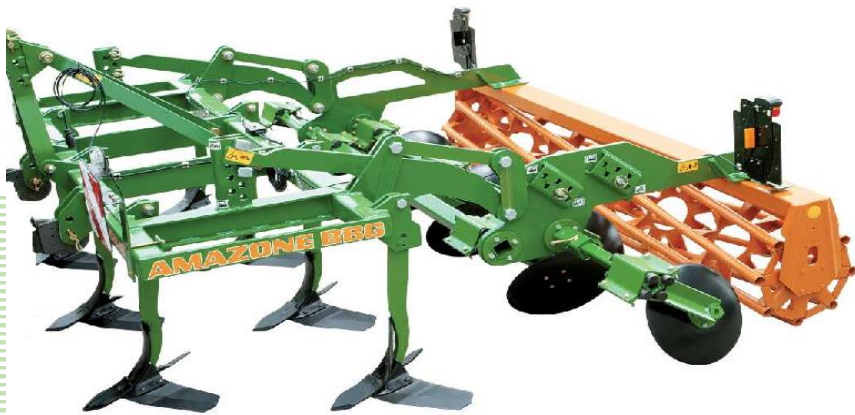
شکل ۱- خاک‌ورز مرکب با کلوخ خرد کن دیسکی و غلتک قفسی شکل
