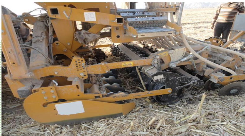
شکل ۶- کمباینات مخصوص انجام همزمان کم خاک‌ورزی و کاشت
