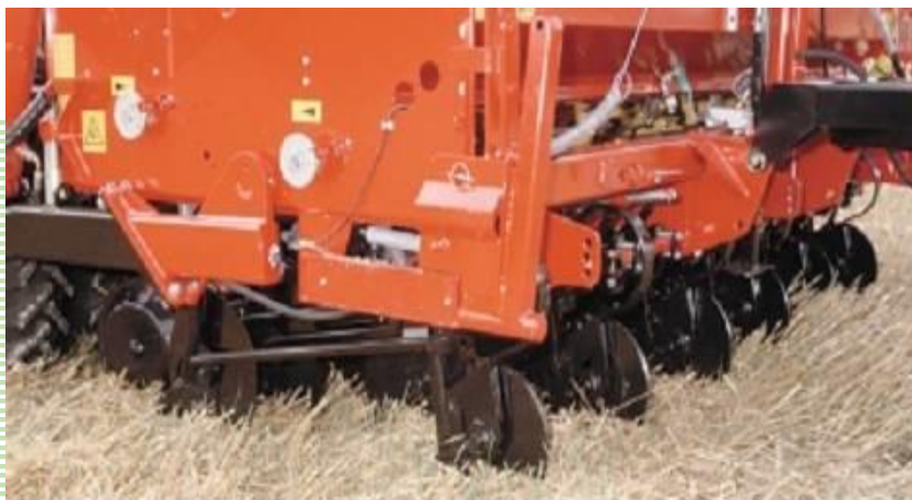
شکل ۵- بذرکار-کودکار مخصوص کاشت بذر در بستر تهیه شده توسط خاک ورز مرکب
