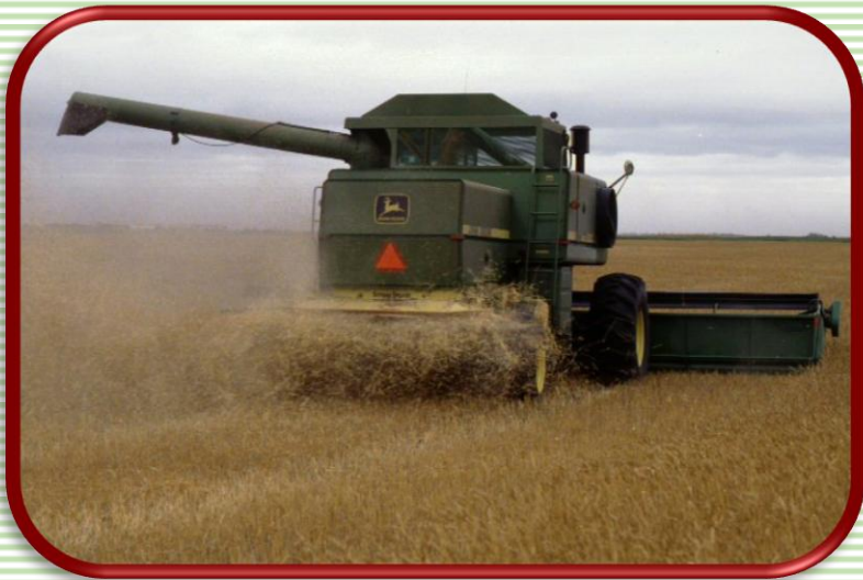
شکل ۳- کمباین مجهز به ساقه خردکن
