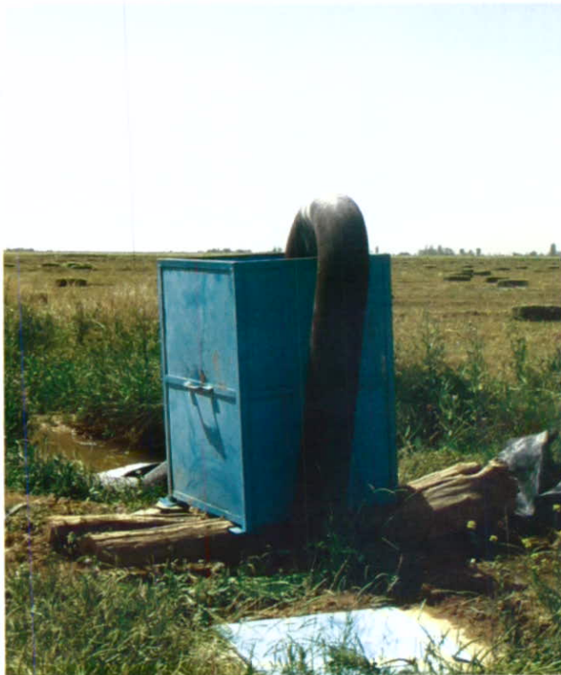
شکل ۷: نحوه آبیگری هیدروفلوم از مخزن آهنی
