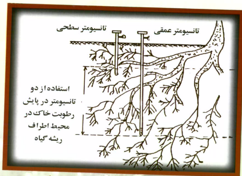
شکل ۴: نحوه کارگذاری تانسیومتر در پای درختان
