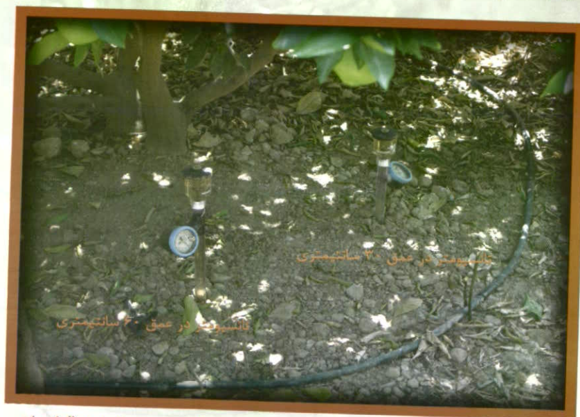
شکل ۵: نمایی از نحوه کارگذاری تانسیومتر در یک سیستم آبیاری قطره ای
