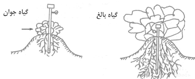
شکل ۵- انتخاب محل نصب یک تانسومتر
