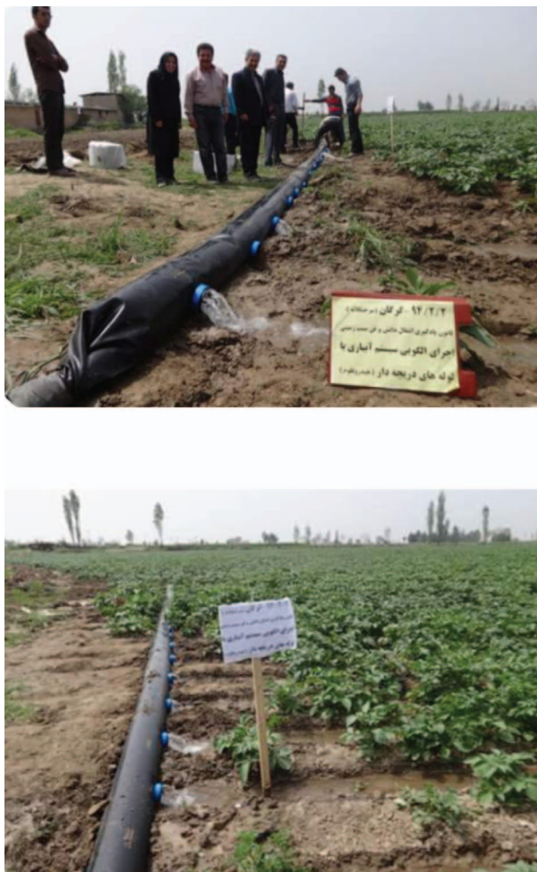
شکل ۵۰- نمونه‌ای از بکارگیری لوله‌های دريچه‌دار در یک مزرعه سیب‌زمینی اراضی گرگان
