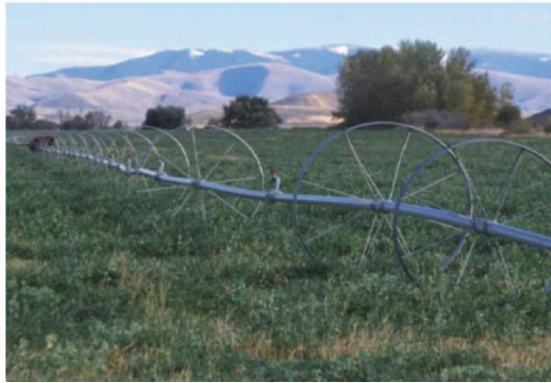
شکل ۵۴- نمایی از یک سیستم آبیاری بارانی ساکن و متحرک دوره‌ای با جابجایی مکانیکی (آبفشان غلطان)
