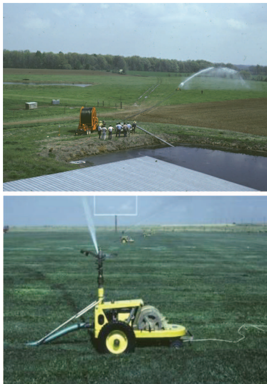
شکل ۵۶- نمایی از یک سیستم آبیاری بارانی متحرک پیوسته با یک آبپاش ( آیفشان قرقره ای)
