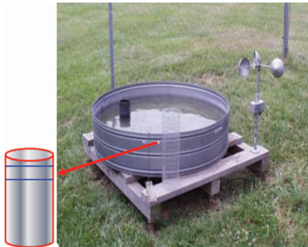
شکل ۲۳- نمایی از تشت تبخیر و اجزای آن
