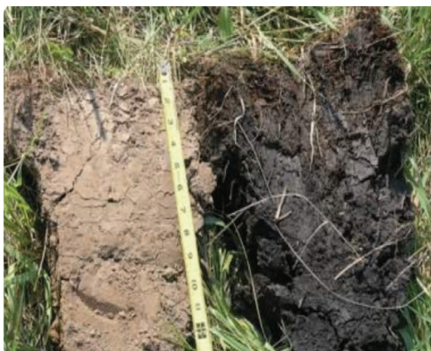
شکل ۲۲- تفاوت بین نیمرخ یک خاک خشک (سمت چپ) و یک خاک مرطوب (سمت راست)
