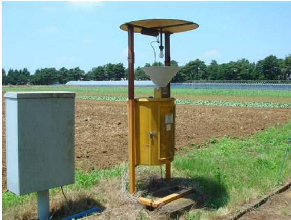
شکل ۸- تله نوری با یک لامپ رشته ای برای مطالعه تغییرات جمعیت و پیش بینی طغیان آفت (شیمودا و هوندا، ۲۰۱۳)
