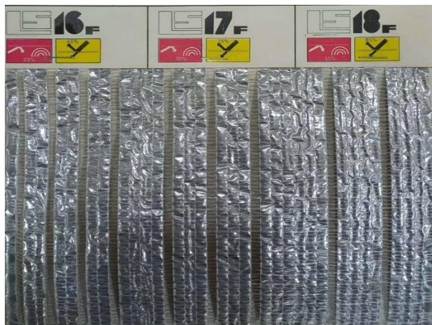
شکل ۲۱- پرده‌های ذخیره انرژی با تراکم‌های مختلف نوارهای آلومینیمی به ترتیب از چپ به راست با ۲۵، ۳۰ و ۳۵ درصد ذخیره انرژی و ۶۵، ۷۵ و ۸۵ درصد سایه‌اندازی
