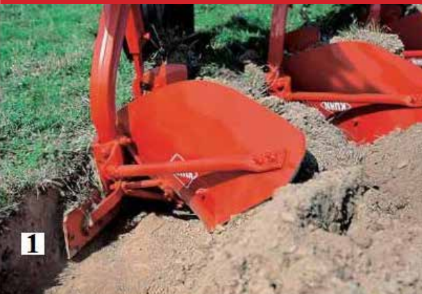
1-Furrow wall ۱- دیواره شیار ضخیم
