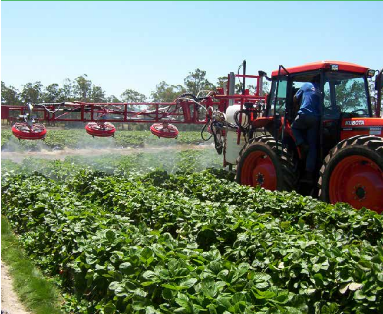
Fan Sprayer سمپاش با فن کمکی
