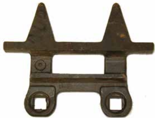
Rock guard انگشتی سنگلاخی = محافظ سنگلاخی
