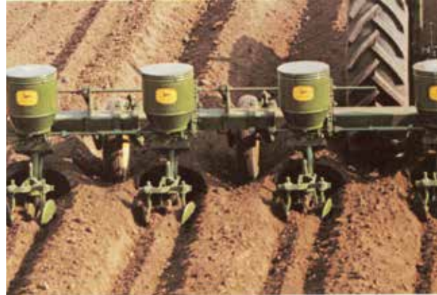
Lister planter = Furrow planter ردیف‌کار مخصوص کشت بذر در کف جوی
