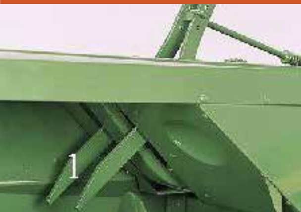
1-Feeder teeth ۱- چنگال تغذیه
