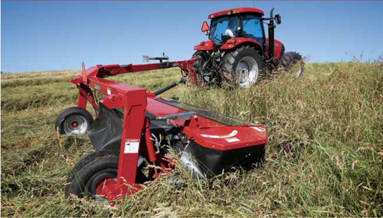
Offset straight pull کشش مستقیم خارج از مرکز
