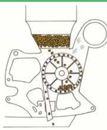
Pressurize seed meter موزع فشاری (نوعی موزع بذر که با فشار هوا کار می کند)
