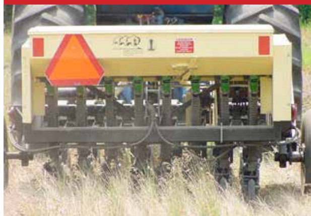
No-Till drill = No-Till planting کشت بدون خاک‌ورزی
