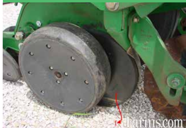
1-Disk opener ۱-شیار بازکن بشقابی
