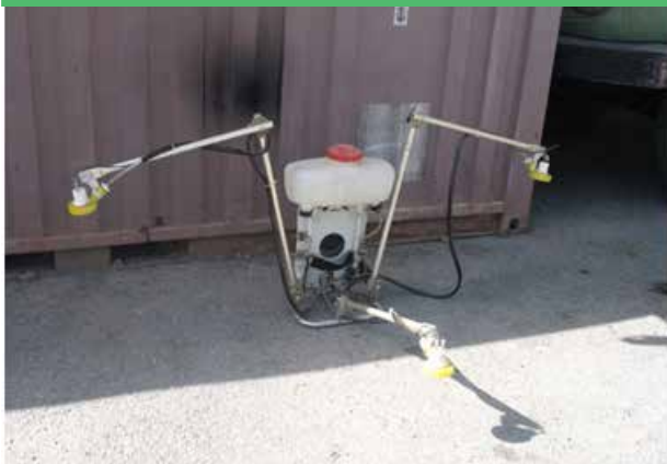
Microner sprayer سمپاش میکرونر
