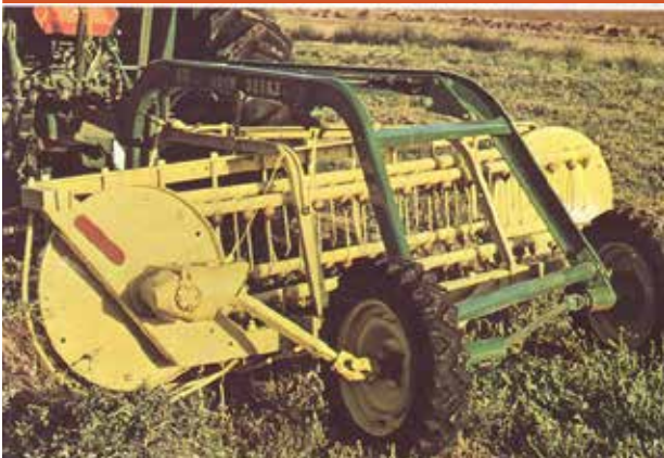
Single parallel rake شانه موازی تکی
