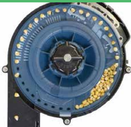
Seed plate metering = Seed plate موزع صفحه ای
