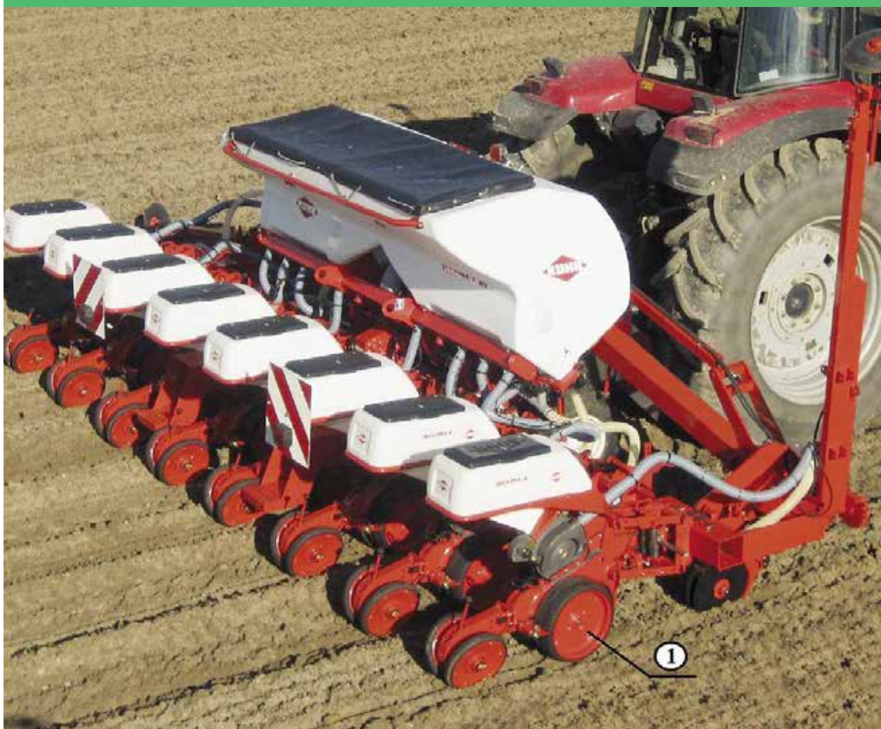
1-Gauge wheel ۱-چرخ تثبیت عمق
