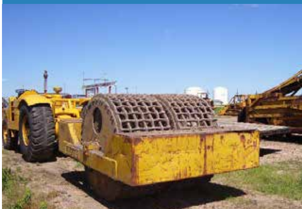
Grid (or mesh) roller غلطک مشبک
