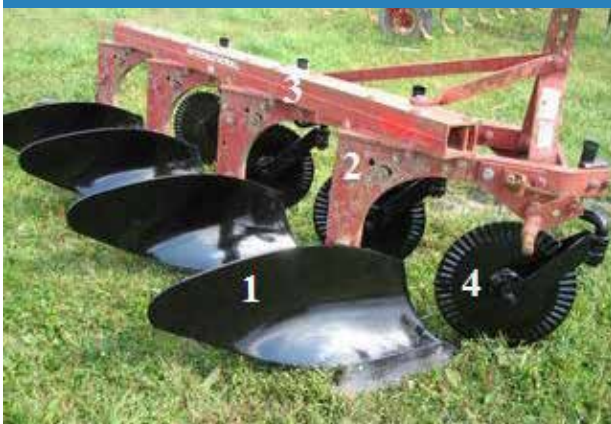
1-Bottom 2- Standard 3- Frame 4- Disk culture = Rolling culture ۱-خیش ۲- ساقه ۳- شاسی ۴- پیش بر بشقابی
