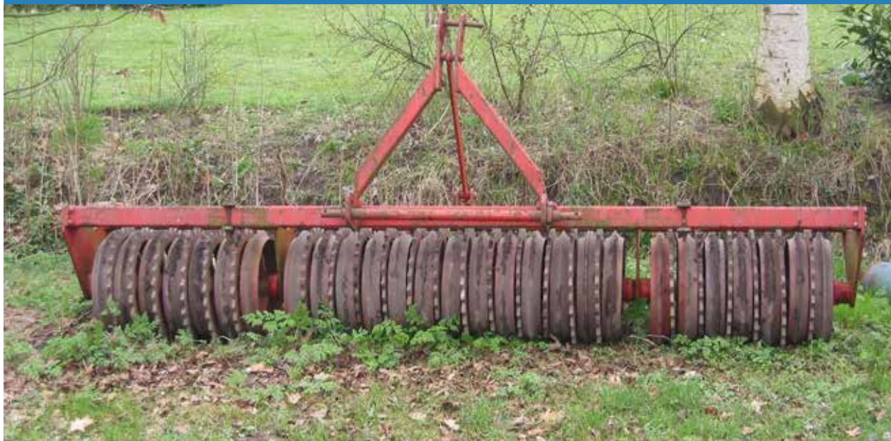
Clot (Clod) crusher غلطک کلوخ شکن
