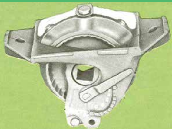
Double run feed موزع دو تایی = موزع دو طرفه
