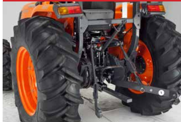
1-Draft arm = lower lift arm = Draft link ۱- بازوی کششی = بازوی بلندکن پایینی
