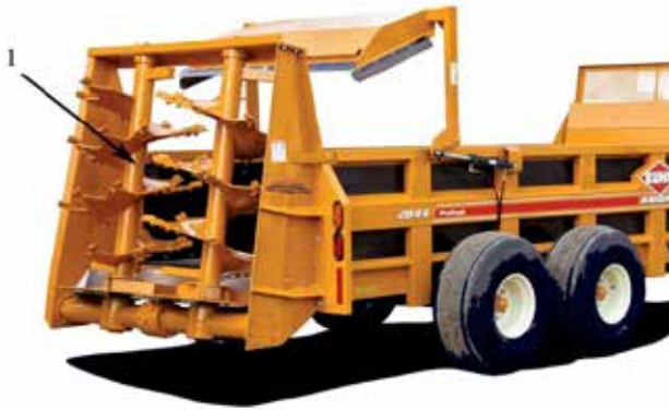
Manure spreader (1- Beater) کودپاش کود دامی (۱-خردکننده-ضربه زن = پخش کن)
