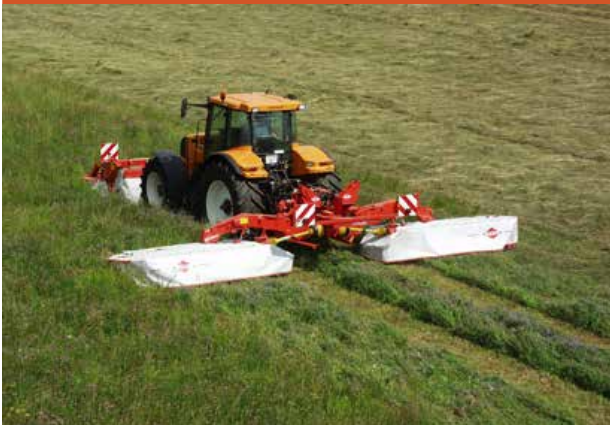
Triple gang disk mower دروگر بشقابی سه تایی
