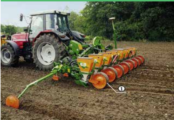
Press gauge wheel (press wheel use as gauge wheel) چرخ فشار که به عنوان چرخ تنظیم عمق استفاده می شود.
