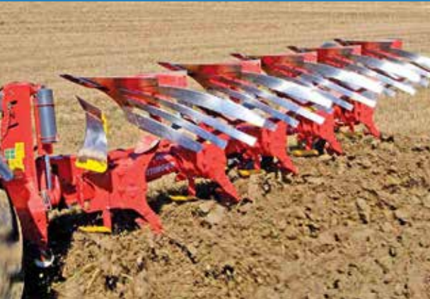
Slatted bottom خیش شکاف دار
