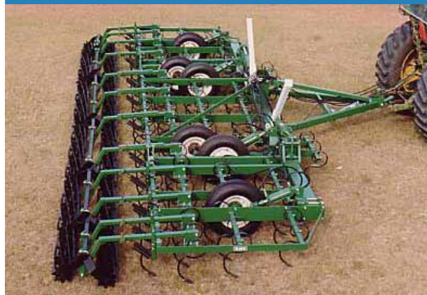
Field cultivator کولتیواتور مزرعه
