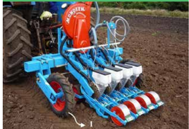
1-Carrying wheel drives ۱- چرخ حمل کننده محرک
