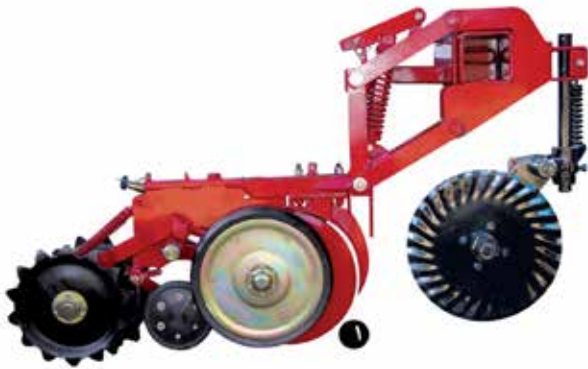
1-Disk opener شیار بازکن بشقابی
