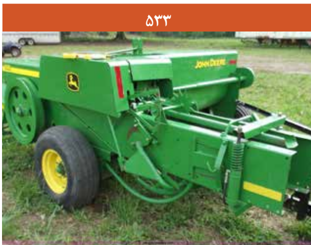
Baler flywheel فلایویل (چرخ لنگر) بسته بند
