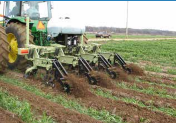
Bed conditioner تهیه کننده خاک بستر بذر
