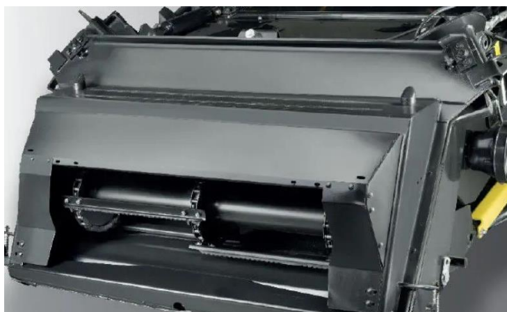
شکل ۸۷- استوانه تغذیه و زنجیر نقاله
