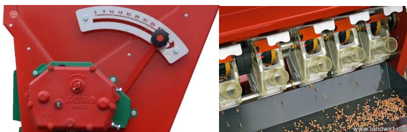
شکل ۵۴- تغییر سرعت چرخش موزع آجدار
