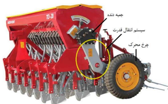
شکل ۴۹- نمای کلی انتقال قدرت از چرخ محرک به محور موزع
