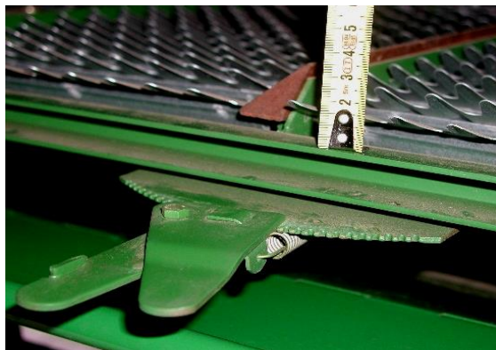
شکل ۱۰۲ - تنظیم سوراخ‌های الک بالایی
