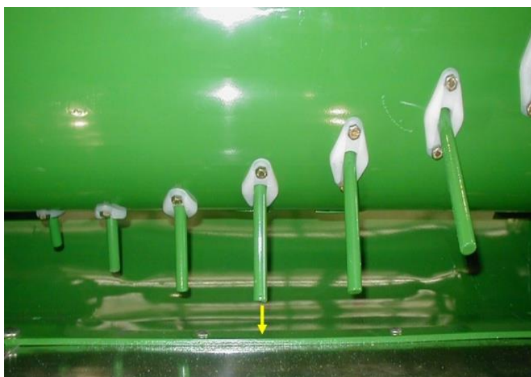
شکل ۱۱۰- فاصله انگشتی‌ها تا کف سکو
