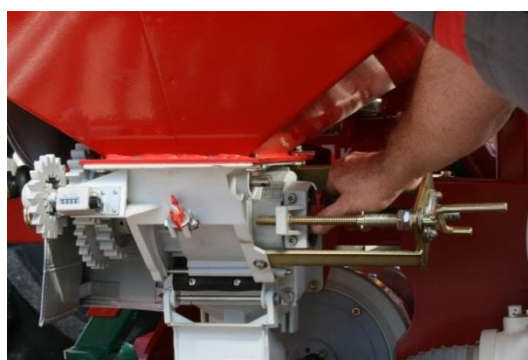
شکل ۶۰- نحوه تنظیم مقدار ریزش بذر
