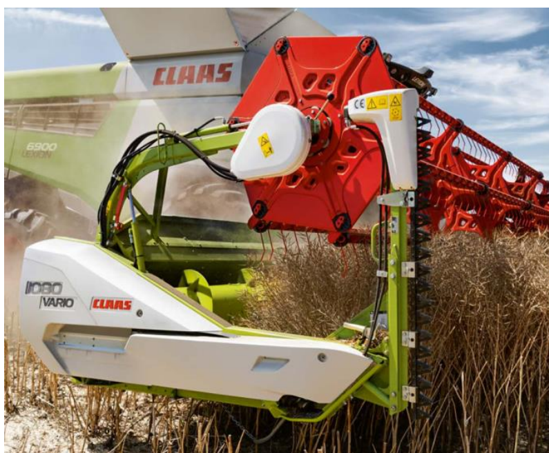
شکل ۸۱- برش عمودی شانه برش عمودی
