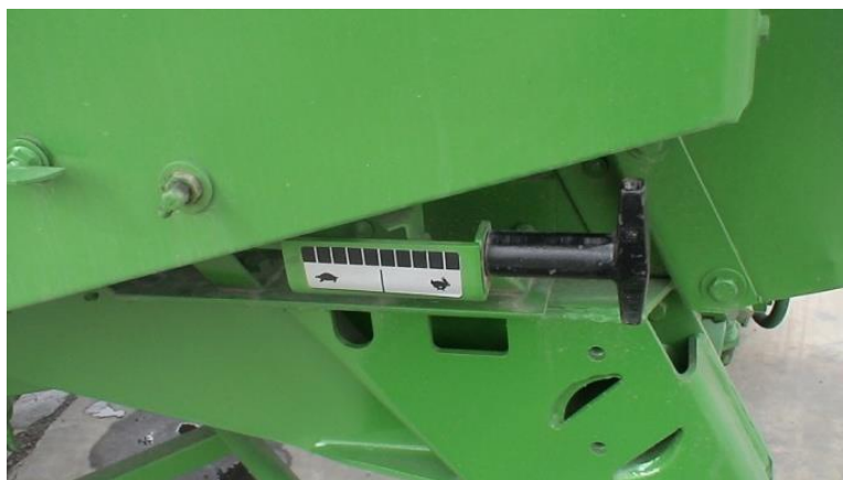
شکل ۱۱۲- دستگیره تنظیم سرعت باد پنکه
