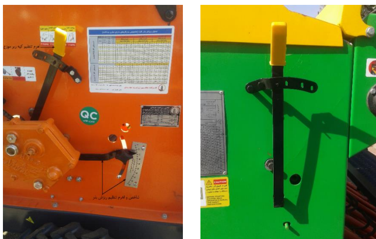
شکل ۶۲- اهرم تنظیم کپه زیر موزع
