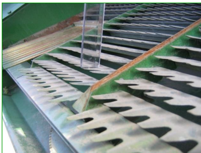
شکل ۱۱۴- اندازه‌گیری فاصله روزنه‌ها برای برداشت کلزا
