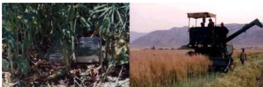
شکل ۱۱۶- اندازه گیری تلفات شانۀ برش (تلفات جمع آوری)
