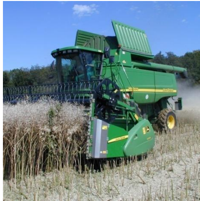
شکل ۷۷- کمباین با هد مخصوص برداشت کلزا دارای تیغه‌های عمودی
