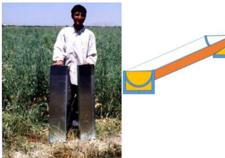
شکل ۱۱۵- ناودانی به ابعاد ۱۰۰ \times ۲۵ سانتی متر برای اندازه گیری تلفات طبیعی محصول
