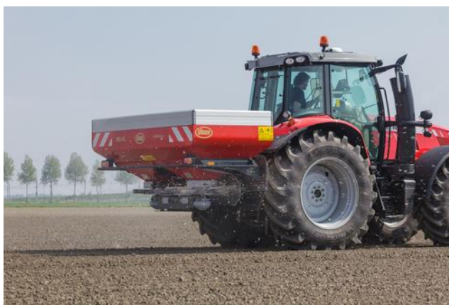
شکل ۳۵- پخش کود با کودپاش گریز از مرکز
