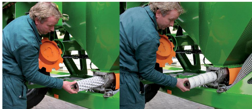
شکل ۶۱- تعویض غلتک (کارتریج) با توجه به اندازه بذر
