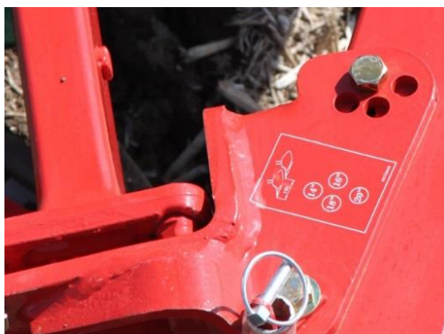
شکل ۲۸- تغییر زاویه هر خیش
