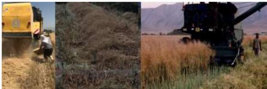
شکل ۱۱۷- اندازه‌گیری تلفات انتهای کمباین (تلفات فرآوری)
