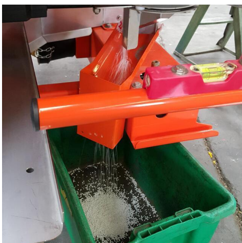
شکل ۴۴- قرار دادن ظرف زیر خروجی مخزن
