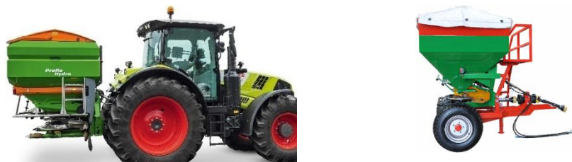
شکل ۳۹- کودپاش کششی (چپ) و سوارشونده (راست)
