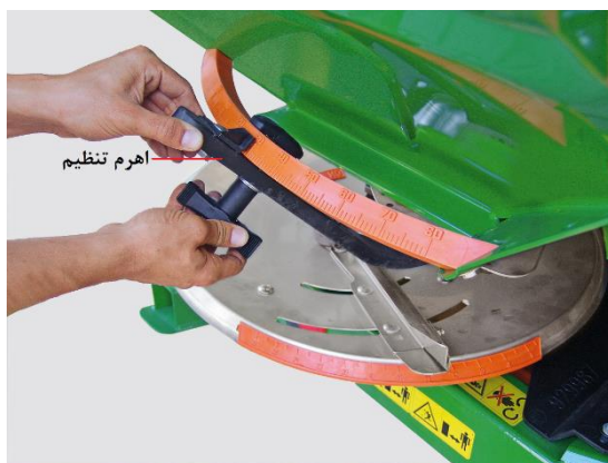
شکل ۴۳- تنظیم دریچه خروجی کود از مخزن
