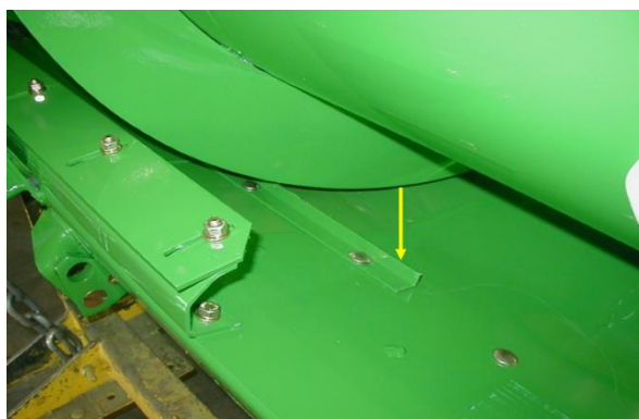
شکل ۱۰۹- فاصله هلیس تا کف سکو
