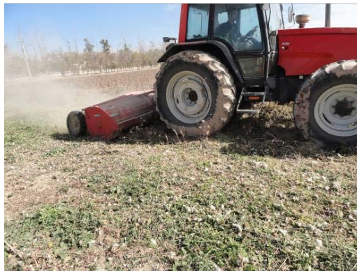
شکل ۴- ساقه خرد کن پشت تراکتوری در حال خرد کردن بقایای پنبه
