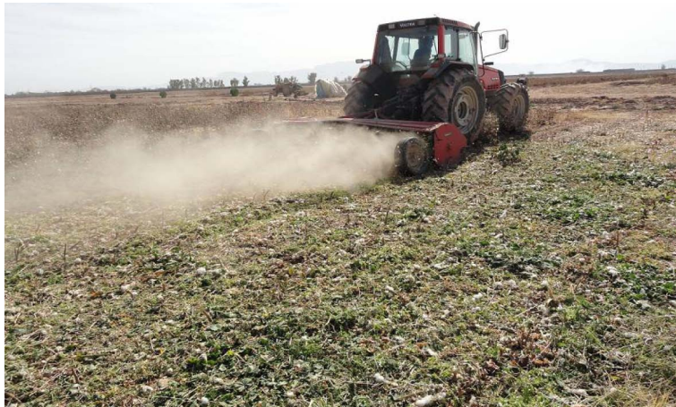
شکل ۳- ساقه خردکن پشت تراکتوری در حال خرد کردن بقایای پنبه
