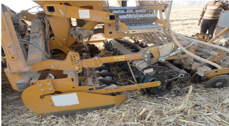
شکل ۶- کمبینات مخصوص انجام همزمان کم خاک‌ورزی و کاشت
