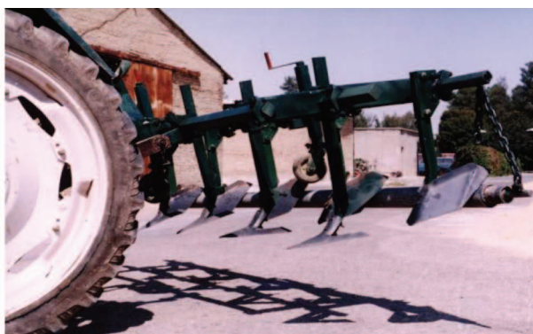
شکل ۷- خاک‌ورز مرکب مورد استفاده در روش کاشت روی پشته‌های بلند و عریض
