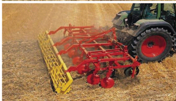
شکل ۱۲- خاک ورنز مرکب (چیزل با تیغه‌های پنجه‌غازی + دیسک + غلتک)
