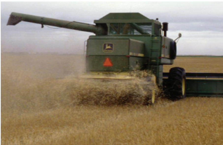
شکل ۳ - کمباین مجهز به ساقه‌خردکن
