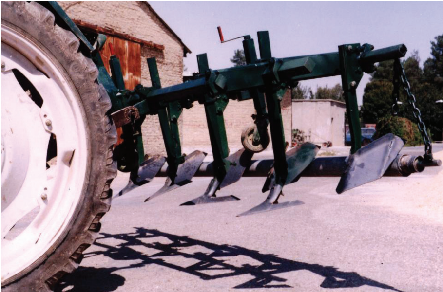
شکل ۸ - خاک ورز مرکب مورد استفاده در روش کاشت روی پشته های بلند و عریض
