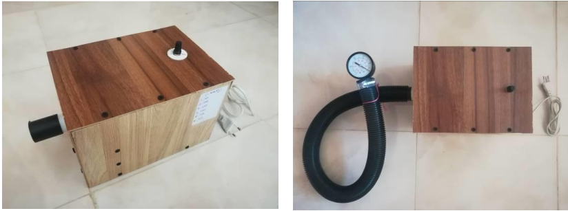
شکل ۳- دستگاه اندازه‌گیری مقدار مکش و برچسب نتایج واسنجی آن
