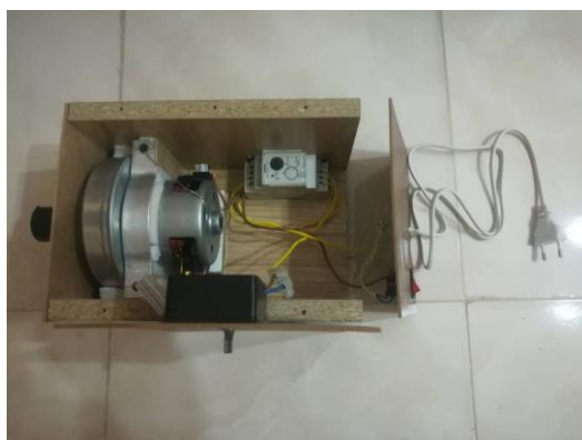
شکل ۲- موتور با فن مکشی به همراه دستگاه های دیمر و تایمر
