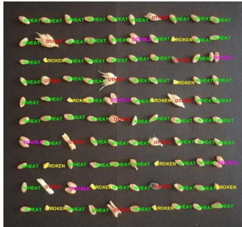
شکل ۱۱- اجرای الگوریتم تعیین میزان شکستگی، ناخالصی و تعداد بذر گندم
