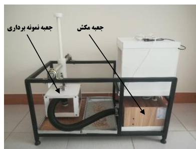
شکل ۱- بخش های مختلف سامانه بینایی ماشین
