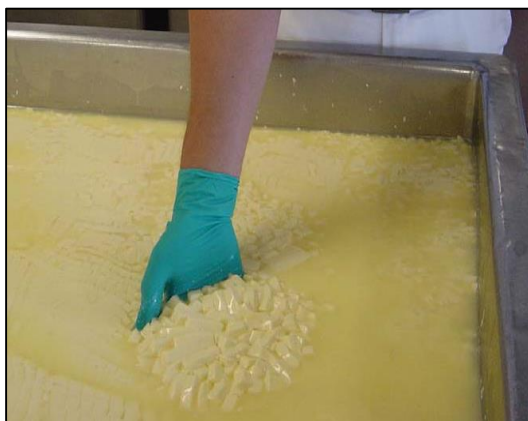
شکل ۸- نمای دلمه پس از برش به شکل قطعات مکعبی 1 \times 1 \times 1 سانتی متری (Anon)
