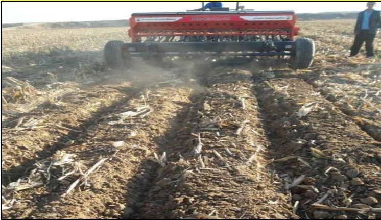
شکل ۴ - کشت گندم با ماشین ویژه کشت روی پشته‌های بلند
