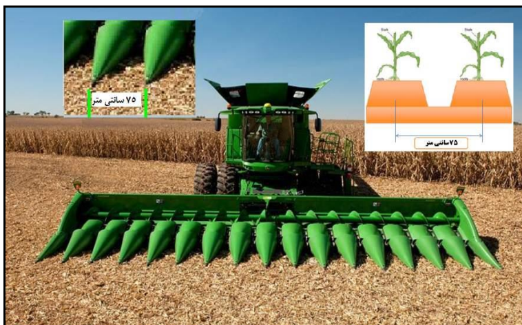
شکل ۱۴ - الگوی استاندارد کاشت ذرت دانده ای و ماشین برداشت برای فاصله ردیف های ۷۵ سانتی متر
