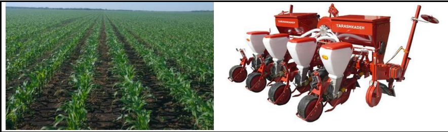
شکل ۱- ماشین فاروئر- ردیف کار ویژه کشت محصولات ردیفی بر روی پشته
