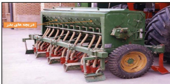
شکل ۲۰ - بستن برخی از دریچه‌های بذر در خطی کار برای نکاشتن بذر در داخل شیارهای آبیاری
