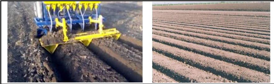
شکل ۱۱ - ایجاد پشته‌های بلند با کمبینات مجهز به شیب‌ر قابل تنظیم
