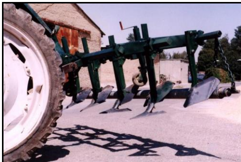
شکل ۲۵ - خاک ورز مرکب مورد استفاده در روش کاشت روی پشته‌های بلند دائمی
