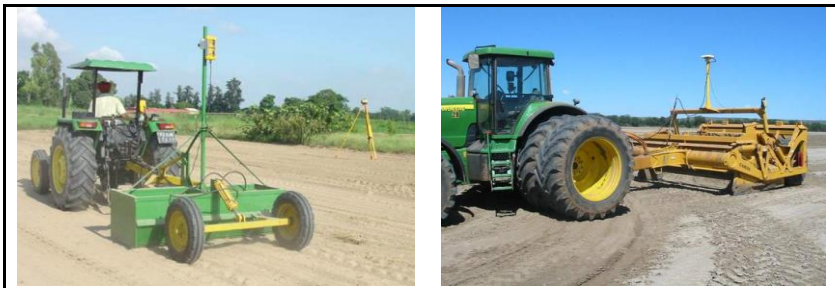
شکل ۶ - تسطیح زمین توسط لولر لیزری
