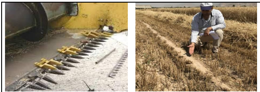
شکل ۷- برخورد تیغه‌های کمباین به مرزها در آبیاری مرسوم (راست) و شکستن مکرر تیغه شانه برش کمباین (چپ)
