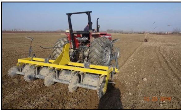
شکل ۱۲ - استفاده از فاروئر غلتکی برای ایجاد بستر و شیار در مزرعه برای کشت روی پشته‌های بلند دائمی در سال اول
