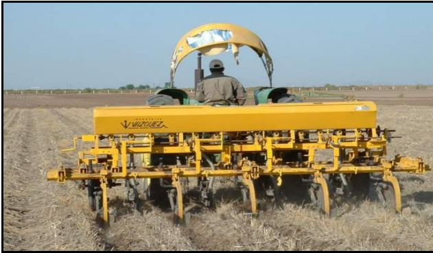
شکل ۱۰ - شکل دادن مجدد به شیارها یا فاروهای آبیاری در سامانه بسترهای بلند دائمی بدون تخریب بسترها
