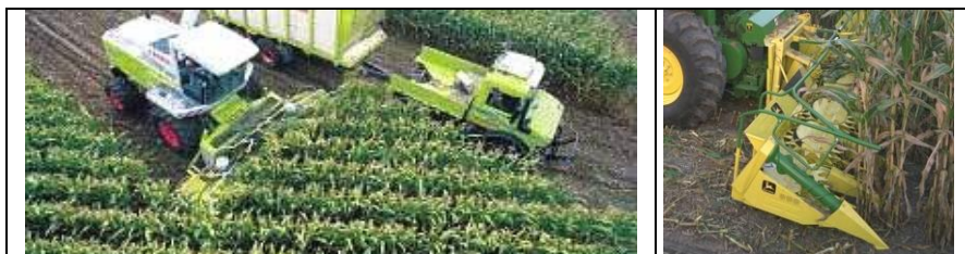
شکل ۱۷- چابِر مستقل از فاصله ردیف، برای رفع محدودیت ابعاد پشته‌های بلند گندم در تناوب با ذرت علوفه‌ای
