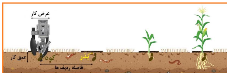
شکل ۳۲- قرارگیری کود و بذر در عمق‌های مختلف (منبع: سام سون، ۲۰۲۱)
