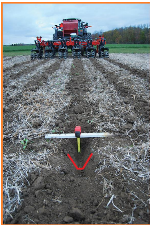
شکل ۳۳- ایجاد شیار V یا U شکل توسط ساق زیرشکن
