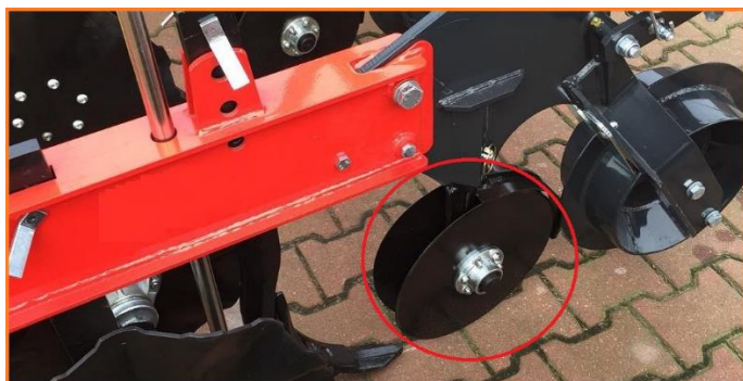
شکل ۲۹- ردیف ساز بشقابی مقعر لبه صاف
