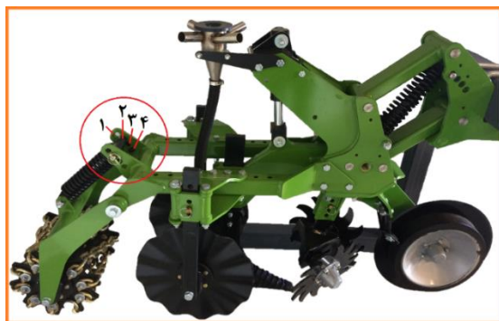
شکل ۷۱- تنظیم فشار فنر غلتک خاک کوب
