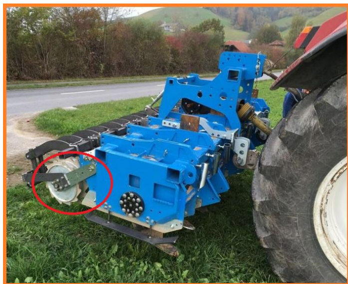
شکل ۹۱- تنظیم ارتفاع غلتک دندانه‌دار با جابجایی بازوی غلتک روی شاسی
