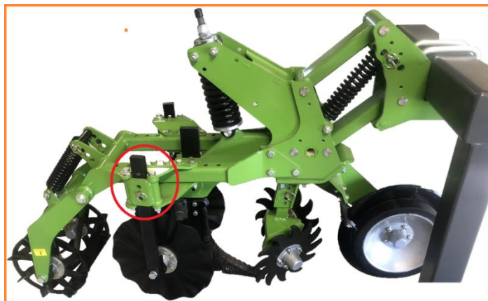
شکل ۶۹- تنظیم ارتفاع بشقاب‌ها
