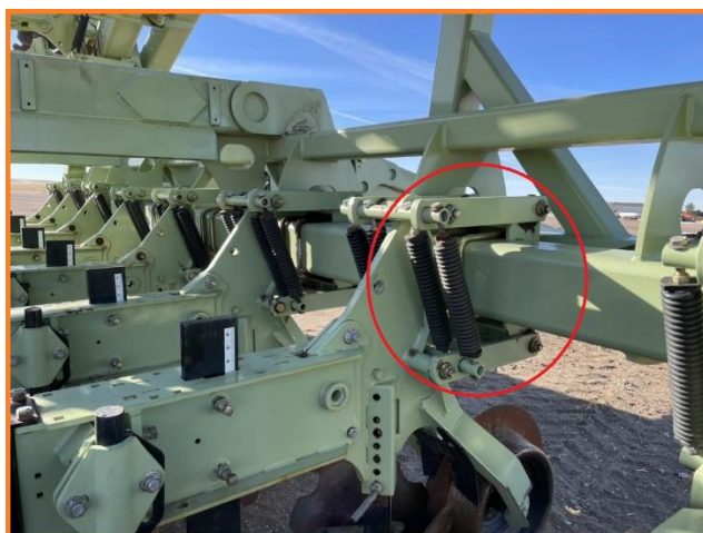
شکل ۶۱- روش استفاده از قاب متوازی‌الاضلاع برای کنترل عمق اختصاصی شیار بازکن
