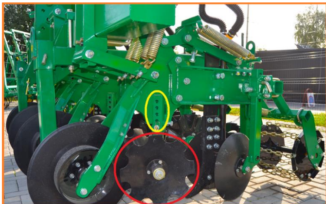
شکل ۲۸- ردیف ساز بشقابی مقعر لبه کنگره‌ای
