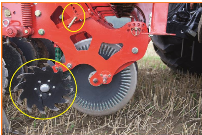
شکل ۲۷- تنظیم عمودی چرخ انگشتی دار
