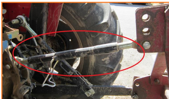
شکل ۵۷- تغییر طول بازوی میانی تراکتور به منظور تنظیم تراز طولی
