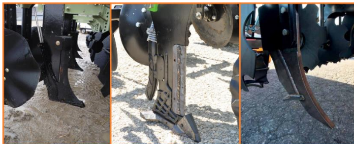
شکل ۳۱- انواع ساق زیرشکن مورد استفاده به عنوان شل کننده در خاک‌ورز نواری غیرفعال
