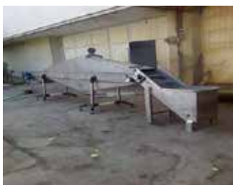
دستگاه پوشش‌دهنده فیلم خوراکی روی میوه
