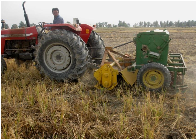
شکل ۸- استفاده از ماشین مرکب خاک‌ورز- کاشت نواری
