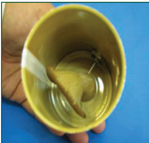
شکل ۲۱- ترموکوپل کنستانتین-مس سوزنی همراه با قارچ دکمه‌ای و صدفی
