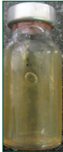
شکل ۱۳- رشد میکروب‌های غیرهوازی مقاوم به حرارت در بطری حاوی محیط کشت دی.آر.سی.ام
