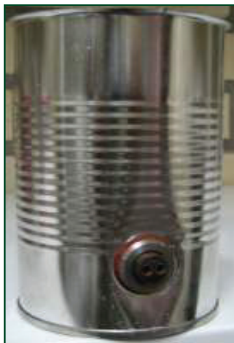
ادامه شکل ۱۹- ترموکوپل نصب شده در قوطی
