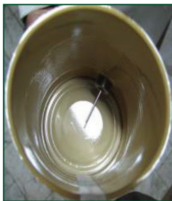
شکل ۲۰- ترموکوپل کنستانتین - مس سوزنی نصب شده در ارتفاع یک‌دهم در داخل قوطی
