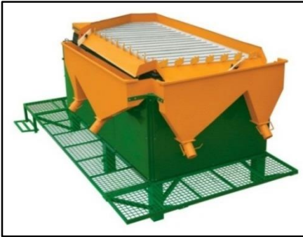
شکل ۷- ماشین جداساز وزنی (گراویتی) در خط فرآوری بذر گندم (رام صنعت بهاره ۱۳۹۰، آذران بوجار ایرانیان ۱۳۹۳)
