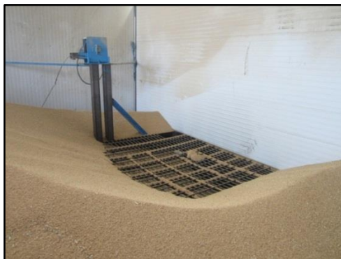
شکل ۳- تجمع گندم بذری قبل از چاله ورودی بالابر ماشین پیش‌بوجار (گازر و همکاران، ۱۳۹۹)
