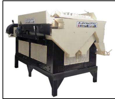
شکل ۷- ماشین جداساز وزنی (گراویتی) در خط فرآوری بذر گندم (رام صنعت بهاره ۱۳۹۰، آذران بوجار ایرانیان ۱۳۹۳)
