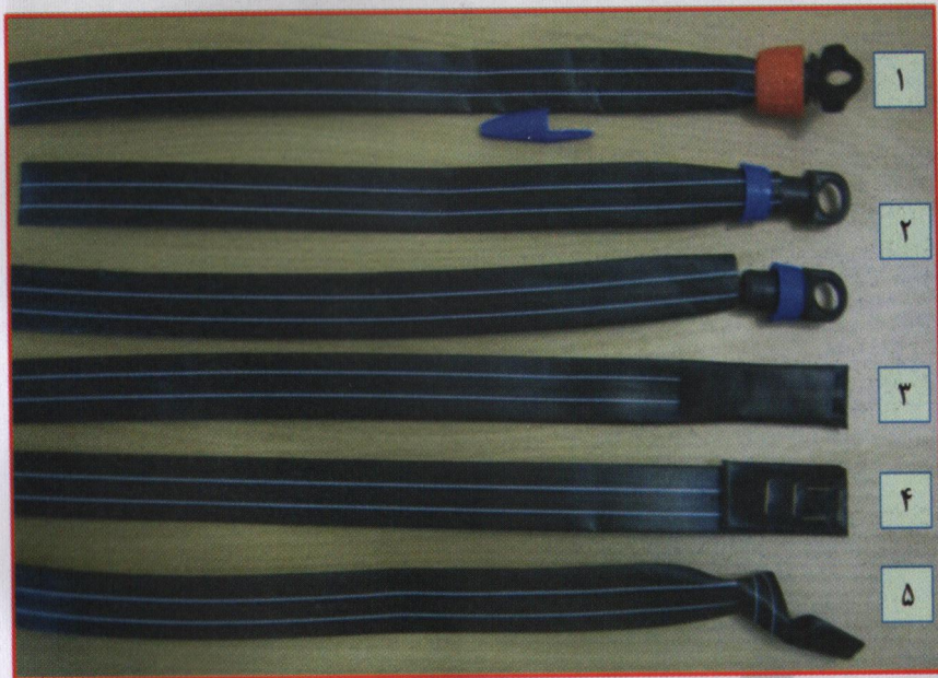
شکل ۱۳- حالت های مختلف بستن انتهای لوله تیپ
