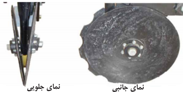
شکل ۵- شیار بازکن دوتایی صفحه تخت از دو نمای مختلف
