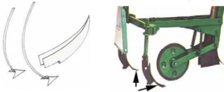
شکل ۱۳- طرح واره و تصویری از نحوه قرارگیری پوشاننده چیرلی نسبت به شیاربازکن
