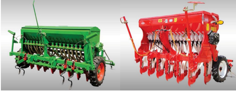
شکل ۳- بذرکارهای مجهز به شیاربازکن‌های کفشکی ساخت شرکت‌های داخلی
