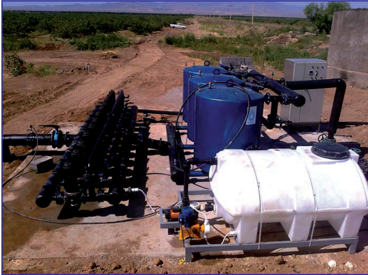
شکل ۱۰- تانک کود برای استفاده از کود آبیاری در مزرعه
