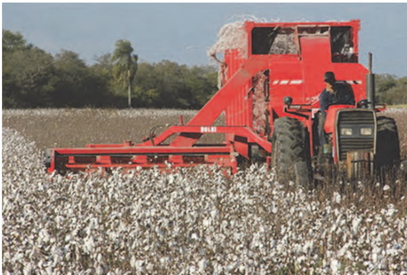
شکل ۱۰- کمباین غوزه‌چین کشتی در حال کار
