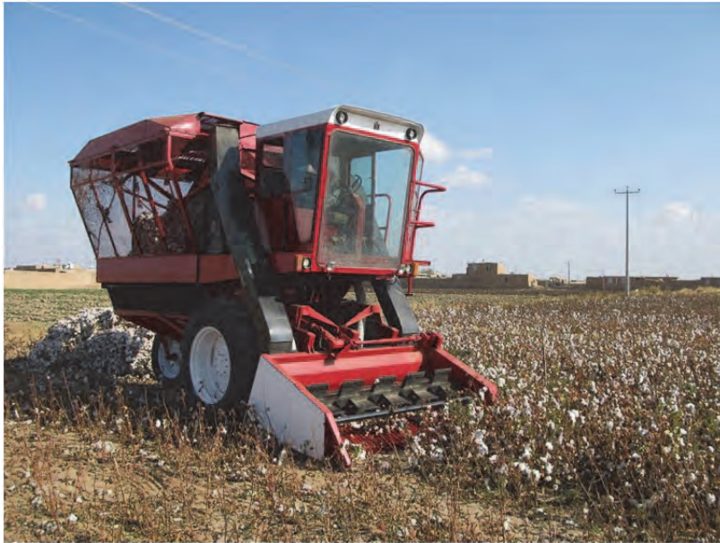
شکل ۱۲- غوزه چین خودگردان (نصب شده بر روی شاسی کمباین وش چین اینترنشنال)
