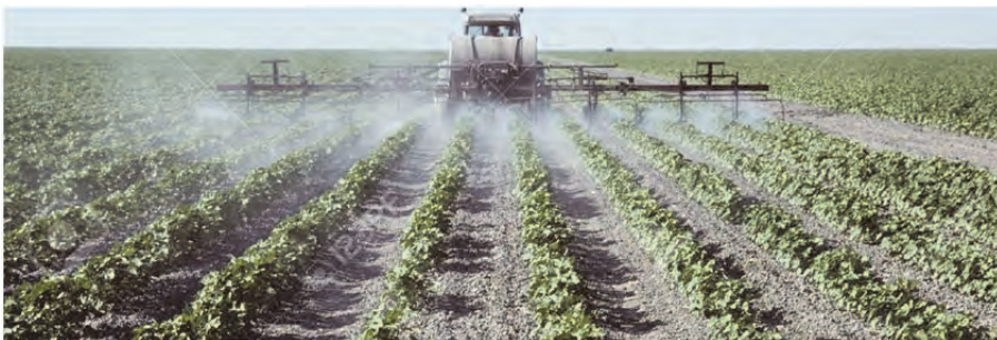
شکل ۶- سمپاش بوم‌دار پشت تراکتوری در حال سمپاشی مزرعه پنبه
