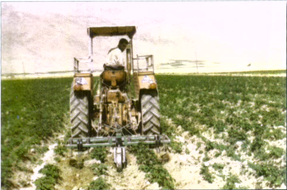
تصویر ۱: اتصال کولتیواتور به سه نقطه اتصال پشت تراکتور
