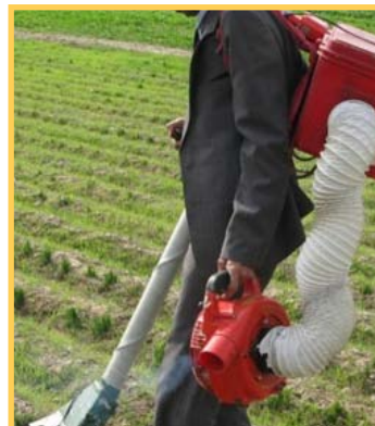
شکل ۱۲. دستگاه سیار برای برداشت گل زعفران، طراحی و ساخته شده در داخل کشور
