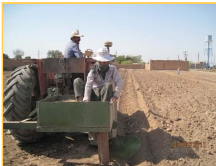
شکل ۵. خیش یک طرفه شده به همراه مخزن پیاز
