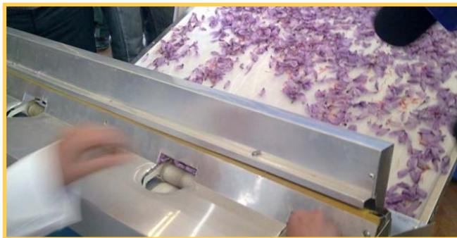
شکل ۱۵. واحد برش گل از دستگاه فرآوری زعفران، طراحی و ساخته شده در داخل کشور
