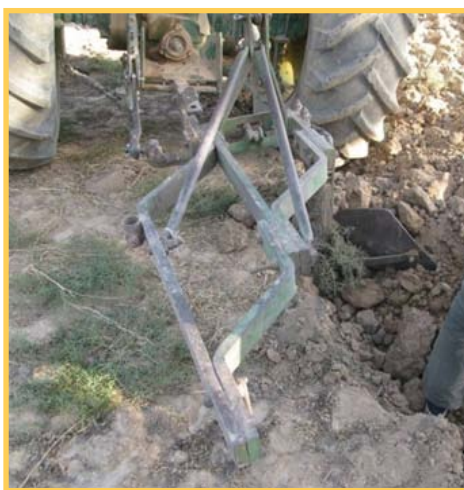
شکل ۲. گاوآهن برگردان دار تک‌خیش برای برداشت و کندن پیازهای زعفران
