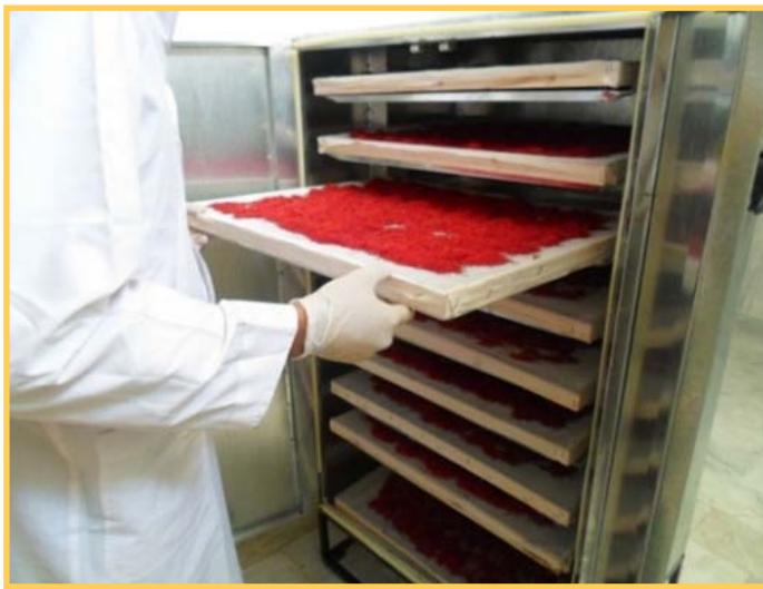
شکل ۱۶. خشک‌کن لایه‌ای در حالت بارگیری سینی‌های محتوی کلاله‌های زعفران
