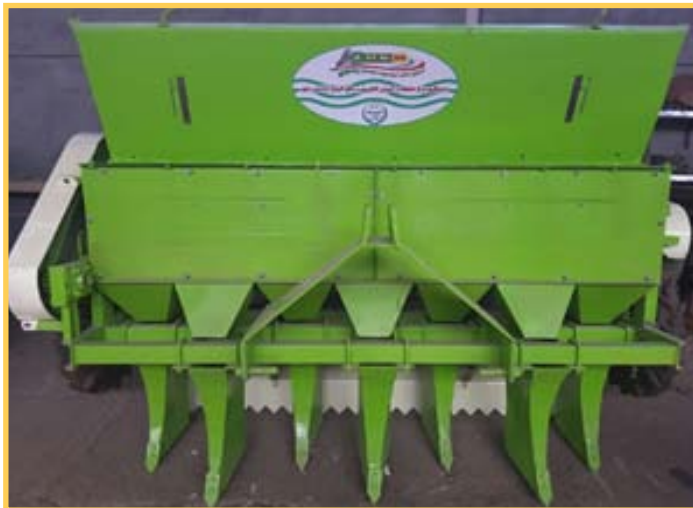
شکل ۷. پیازکار هفت ردیفی تمام خودکار زعفران
