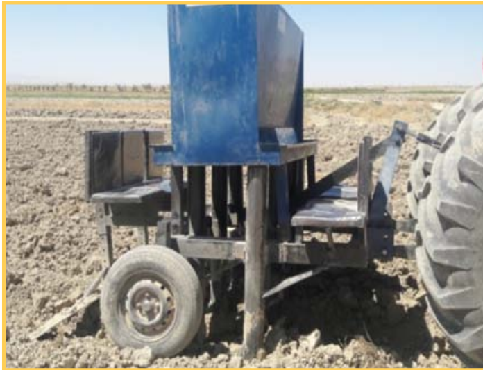
شکل ۶. پیازکار شش ردیفی نیمه خودکار
