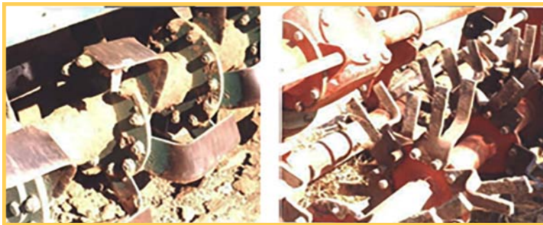
شکل ۹. تعویض تیغه های L شکل با تیغه های عمودی سه شاخه ای؛ سمت راست: تیغه های L شکل رایج، سمت چپ: تیغه های جایگزین شده
