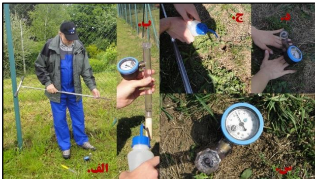
شکل ۹- روش نصب تانسئومتر در مزرعه: الف- حفر چاهک، ب- مرطوب کردن کلاهک سرامیکی، ج- مرطوب کردن چاهک، د- پر کردن فاصله بدنه چاهک با تانسئومتر، س- قرائت درجه خلاء سنج.
