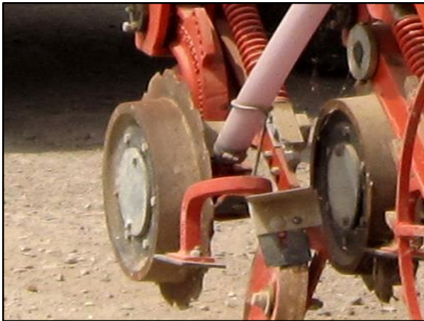
شکل ۲۳- شیار بازکن تک دیسکی کنگره‌دار مخصوص کار در زمین پوشیده از بقایای گیاهی
