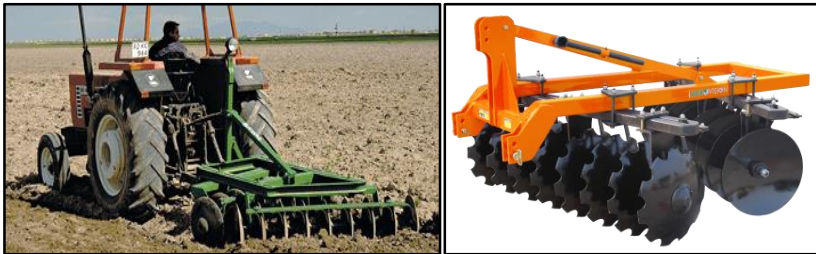
شکل ۲- عملیات دیسک زنی بر روی زمین شخم خورده در خاکورزی مرسوم
