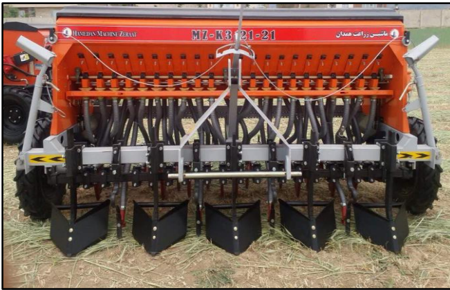
شکل ۳۰- خطی کار کف‌کار ویژه کاشت بذر در اراضی شور
