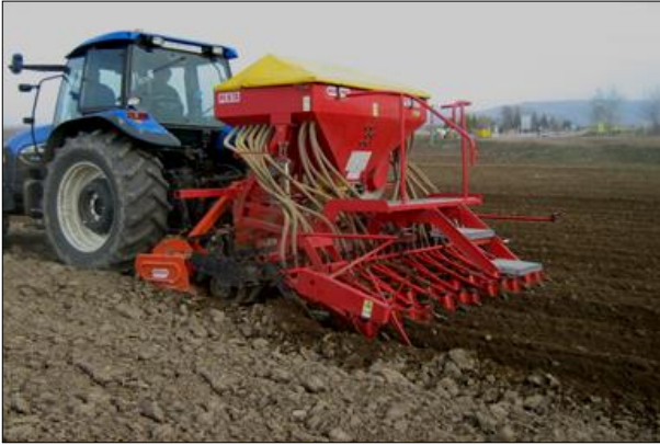
شکل ۲۶- انجام هم‌زمان خاک‌ورزی ثانویه و کاشت بذر با کمبینات
