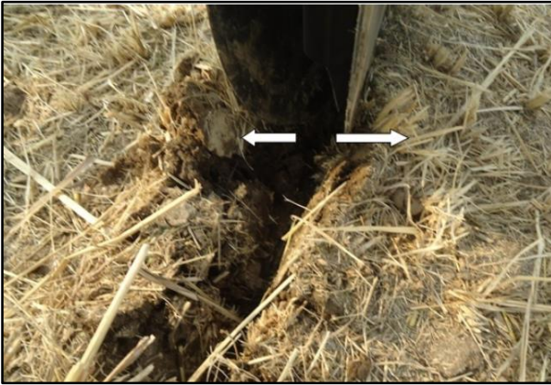
شکل ۲۴- شیار ایجاد شده در خاک با شیاربازکن دو دیسکی
