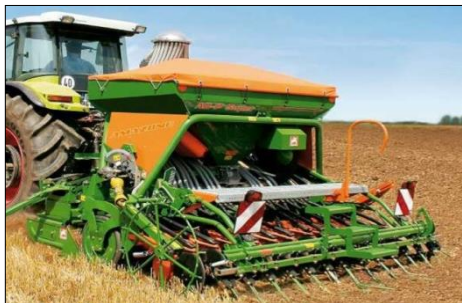
شکل ۲۵- انجام هم‌زمان خاک‌ورزی اولیه، ثانویه و کاشت بذر با کمبینات
