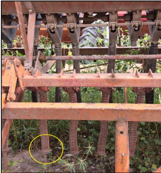
شکل ۳۲- لوله‌های سقوط بدون شیار باز کن برای سقوط آزاد بذر بر روی خاک
