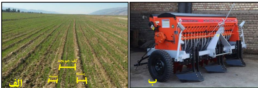
شکل ۶- خطی کار کف کار ویژه کاشت بذر در کف جویچه (الف) و گندم کاشته شده در کف جویچه (ب).
