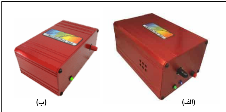
شکل ۶- نمونه دستگاه طیف‌سنج فروسرخ نزدیک (NIR). (الف): با محدوده طول موجی ۹۰۰ تا ۲۳۰۰ نانومتر، و (ب): با محدوده طول موجی ۹۰۰ تا ۱۷۰۰ نانومتر
