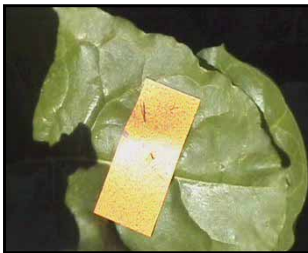
شکل ۴- موقعیت کارت حساس روی برگ‌ها در مسیر سمپاشی
