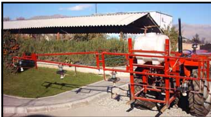
شکل ۳- سمپاش بومدار تراکتوری مجهز به فنجان‌های چرخان
